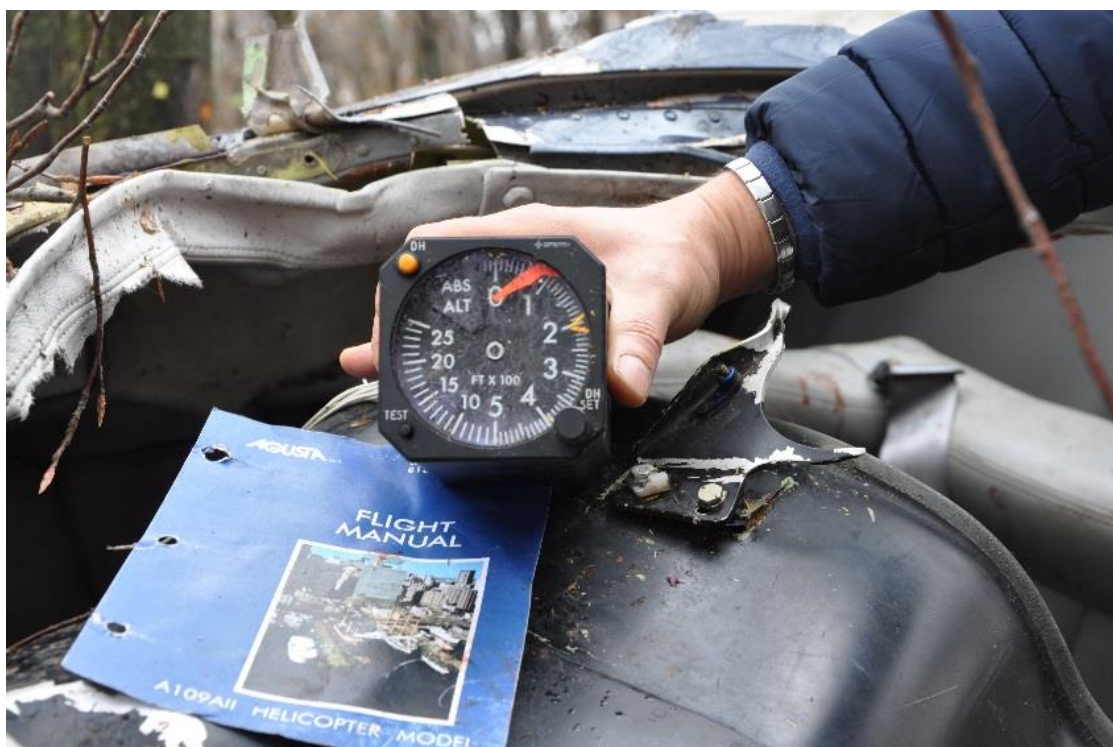
Foto 14: particolare dal radioaltimetro, con avviso settato a 200 piedi.
