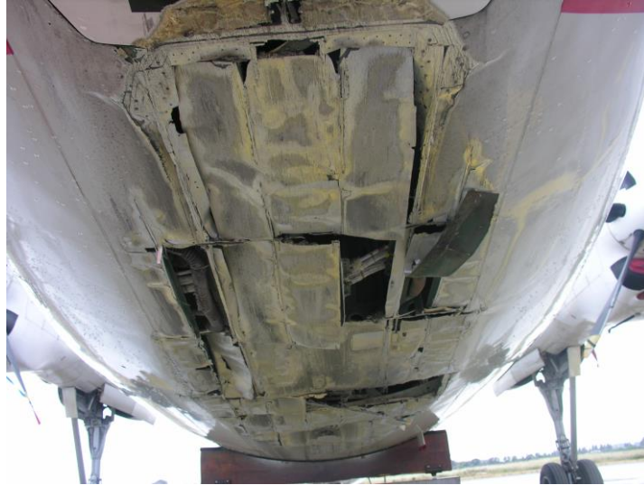
Foto 6: danni nella parte inferiore della fusoliera.
