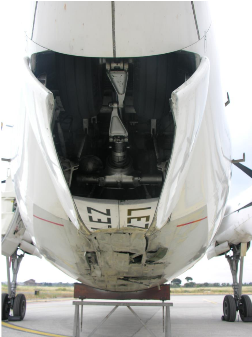
Foto 4: posizione di rinvenimento (iperestesa) del NLG.
