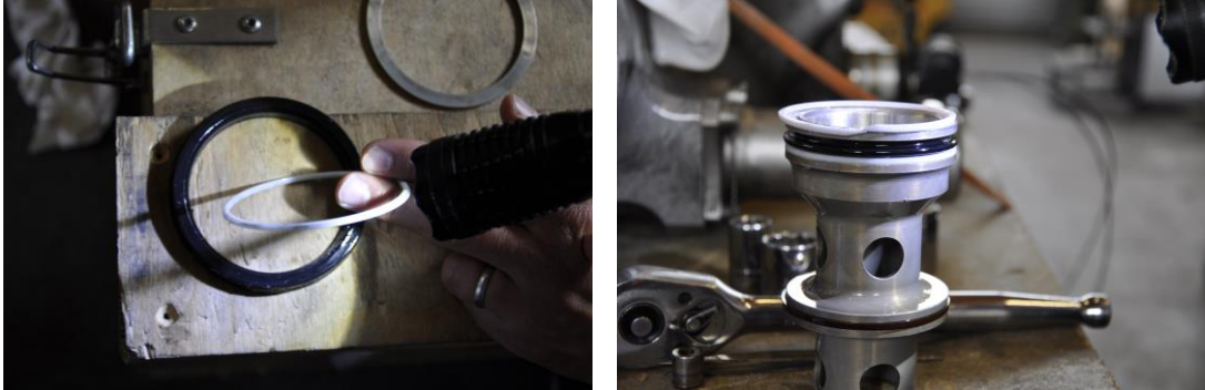
Foto 14 e 15: impropria installazione delle guarnizioni.
