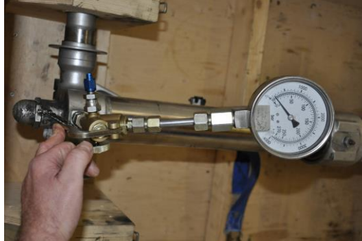
Foto 10: misurazione della pressione dell'azoto.
