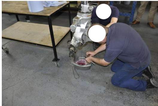
Foto 11: raccolta del fluido idraulico.
