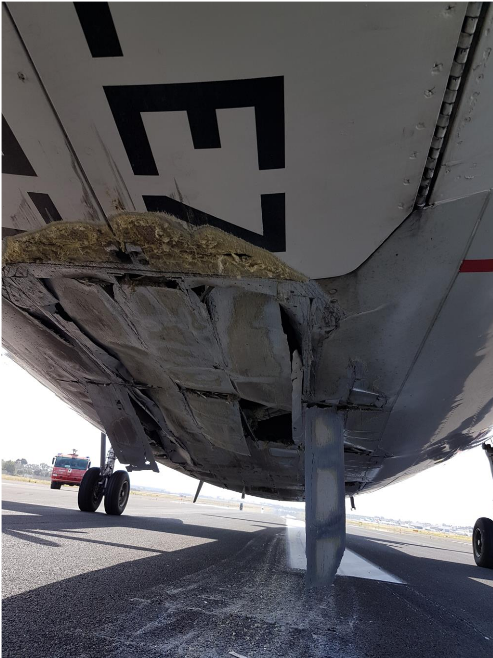
Foto 3: danni da strisciamento nella parte antero-inferiore della fusoliera.
