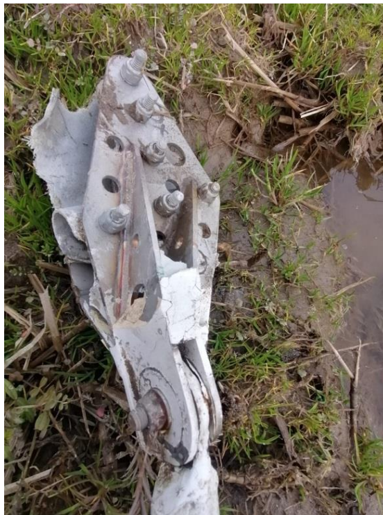
Foto 24: particolare dell'asta di controventatura della semiala destra: punto di attacco inferiore sradicato dalla fusoliera.
