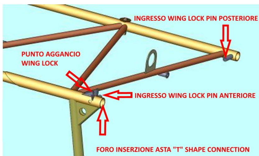
Figura 1: struttura metallica in fusoliera denominata cabane , con in evidenza i punti di attacco della semiala (semiala sinistra).
