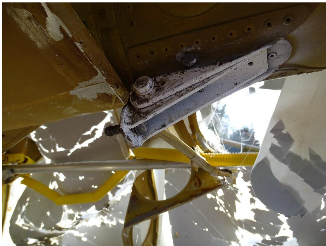
Foto 17: particolare del punto di attacco dell'asta di controventatura semiala sinistra al ventre alare. Si noti la presenza della vite ancora in sede.
