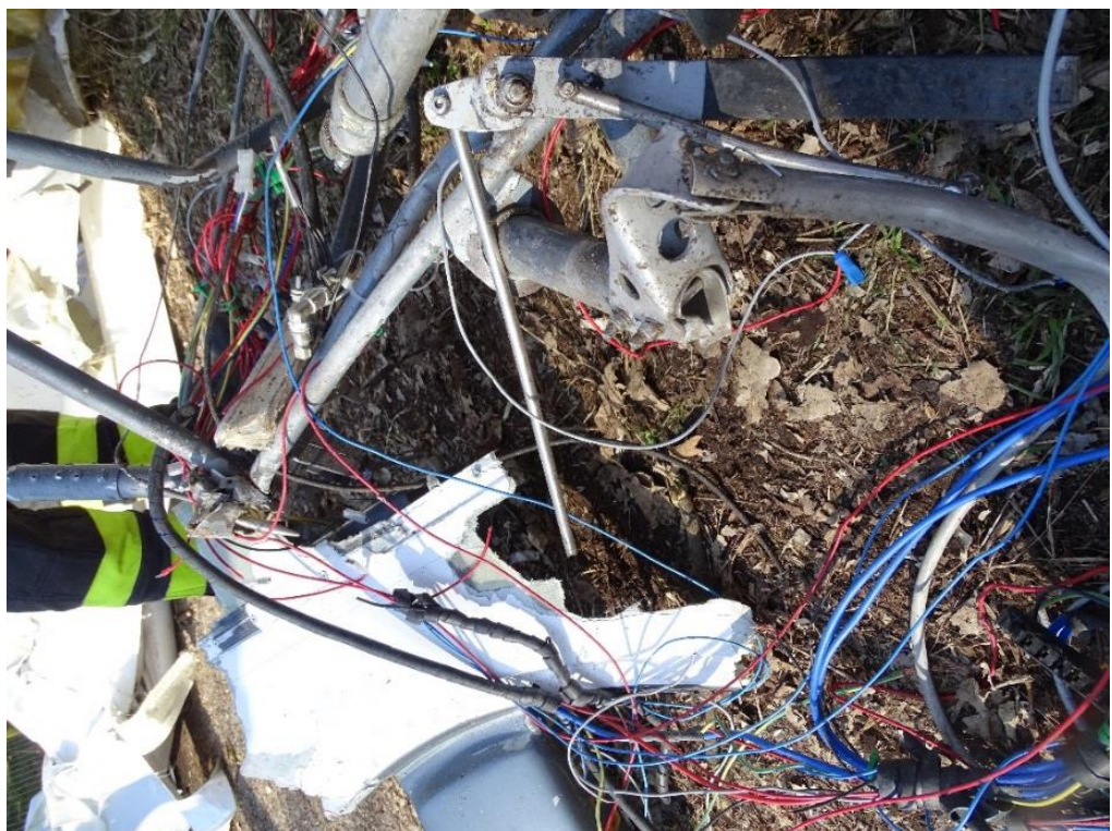
Foto 22: dettaglio del sistema di attuazione dei wing lock pin della semiala destra.
