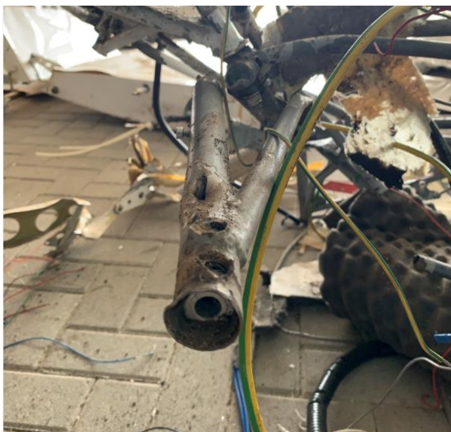
Foto 35: punto di inserimento del wing lock pin posteriore (mancante) della semiala destra.
