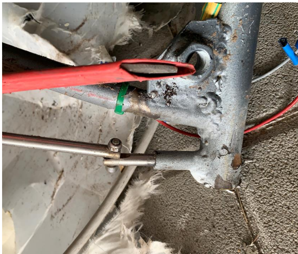
Foto 33: wing lock pin posteriore semiala sinistra.
