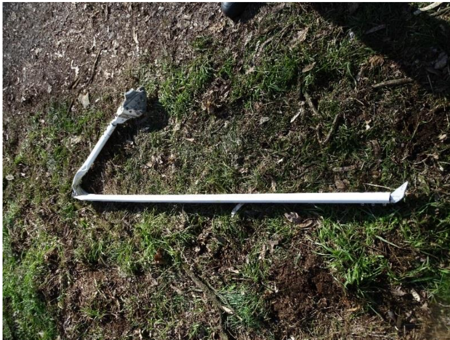
Foto 12: l'asta di controventatura della semiala sinistra recuperata dalla sommità dell'albero.
