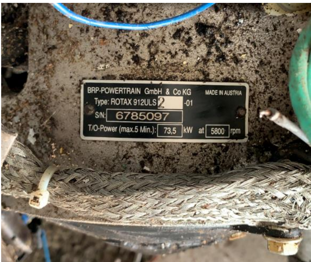
Foto 37: motore Rotax 912 ULS S/N 6785097 installato a bordo dell'apparecchio coinvolto nell'incidente.
