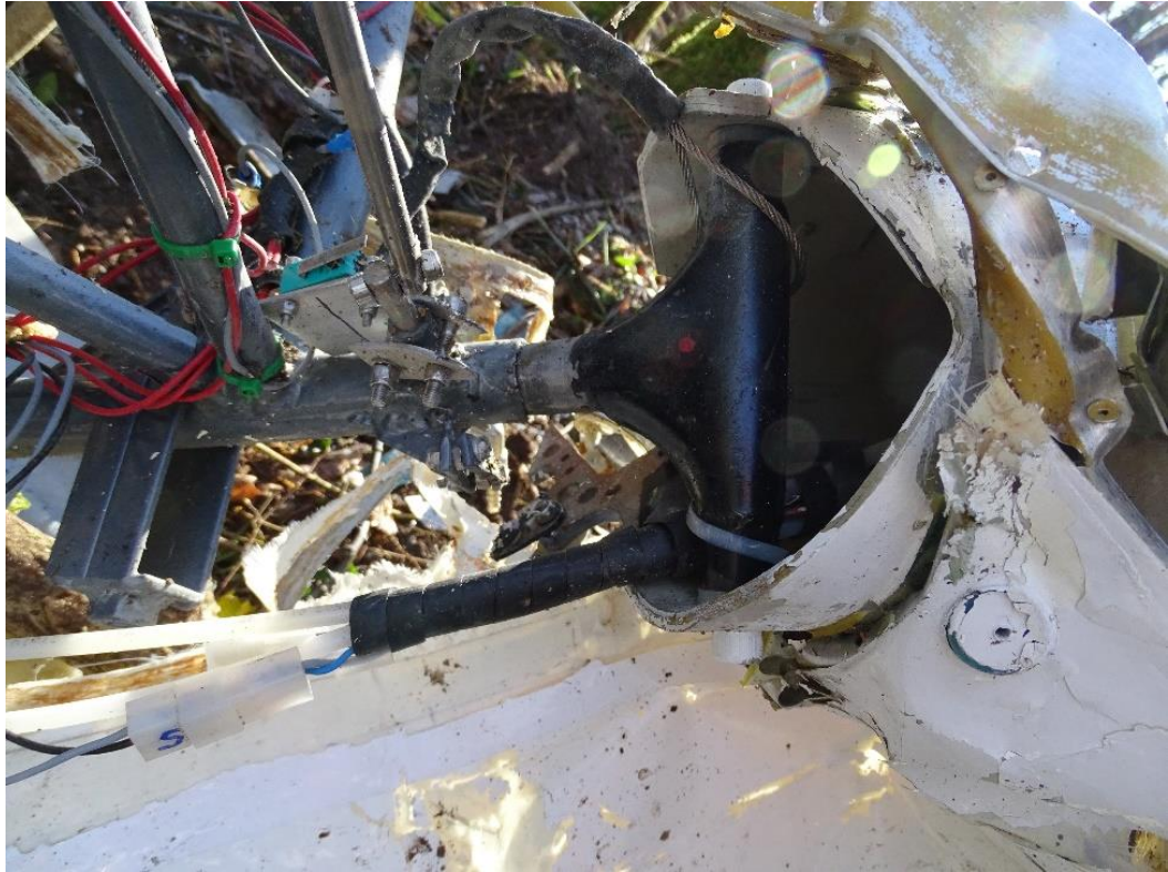
Foto 15: dettaglio del sistema di vincolo della semiala sinistra ( "T" shape connection ).
