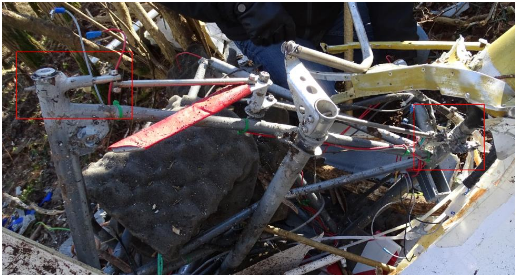
Foto 16: dettaglio del sistema di blocco della semiala sinistra ( wing lock pin anteriore e posteriore).
