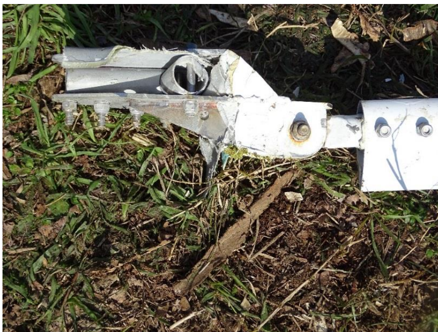
Foto 13: particolare dell'asta di controventatura della semiala sinistra: punto di attacco inferiore sradicato dalla fusoliera.
