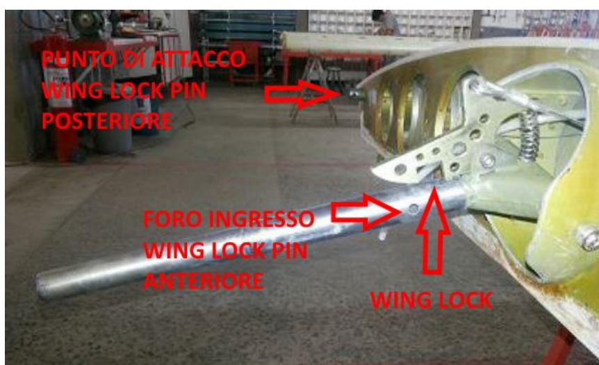
Foto 2: "T" shape connection con evidenziati il wing lock e i due punti di inserimento dei wing lock pin anteriore e posteriore (semiala sinistra).
