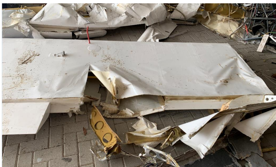
Foto 31: vista del ventre della semiala destra con il segno della possibile interferenza con il disco dell'elica in corrispondenza del bordo di uscita, a circa un terzo della apertura.
