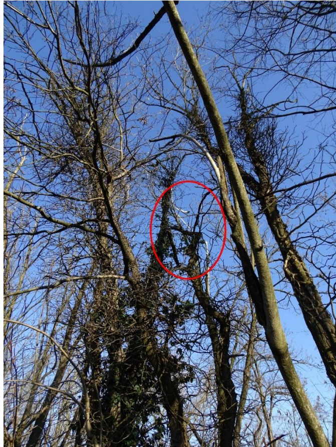
Foto 11: cime degli alberi con rami e tronchi spezzati sulla verticale del punto di impatto. Evidenziata dal cerchio rosso l'asta di controventatura della semiala sinistra.
