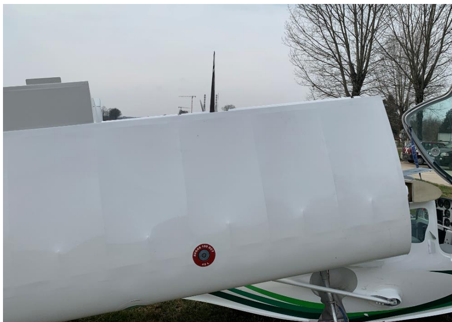
Foto 30: vista della semiala destra ripiegata. Si nota la corrispondenza del disco dell'elica all'incirca al primo terzo della apertura e in corrispondenza del bordo di uscita. Fotografia effettuata durante il sopralluogo ANSV su un apparecchio analogo presente sull'aviosuperficie "Leonardo da Vinci" di Vigevano.
