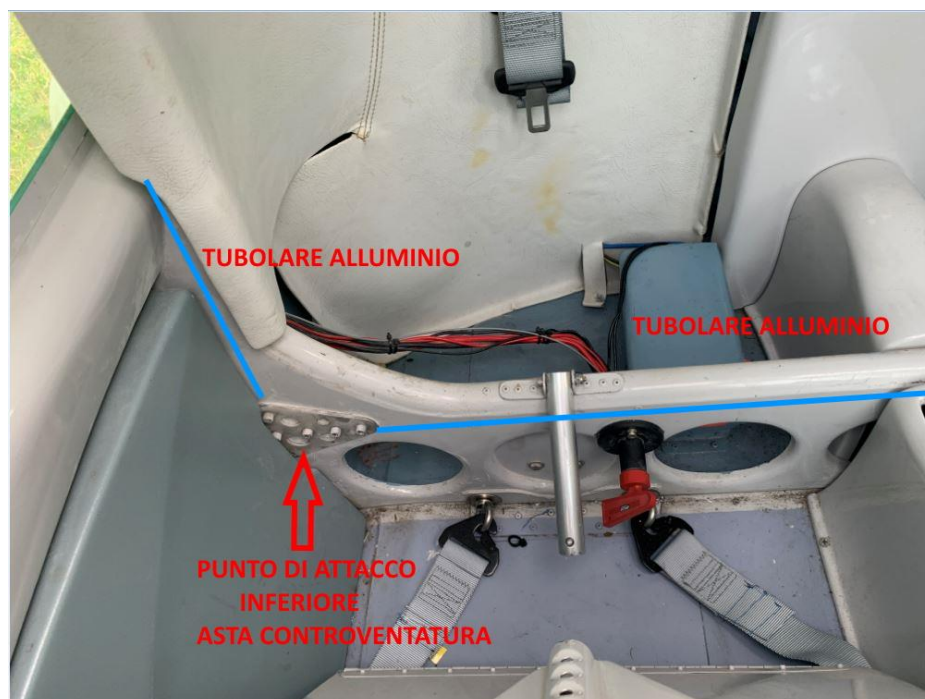
Foto 6: vista frontale piastre metalliche di vincolo dell'asta di controventatura alla struttura dell'apparecchio. In blu sono evidenziate le posizioni dei tubolari di alluminio che costituiscono la struttura (attacco asta controventatura semiala destra). Fotografia effettuata durante il sopralluogo ANSV su un apparecchio analogo presente sull'aviosuperficie "Leonardo da Vinci" di Vigevano.
