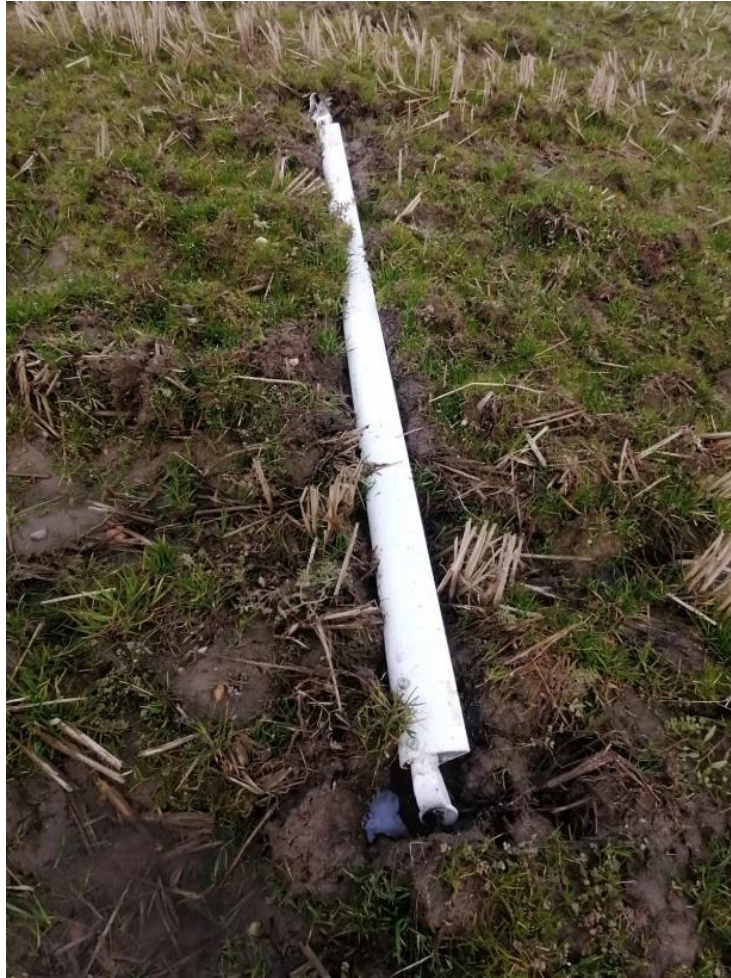
Foto 23: asta di controventatura della semiala destra nel luogo di rinvenimento.
