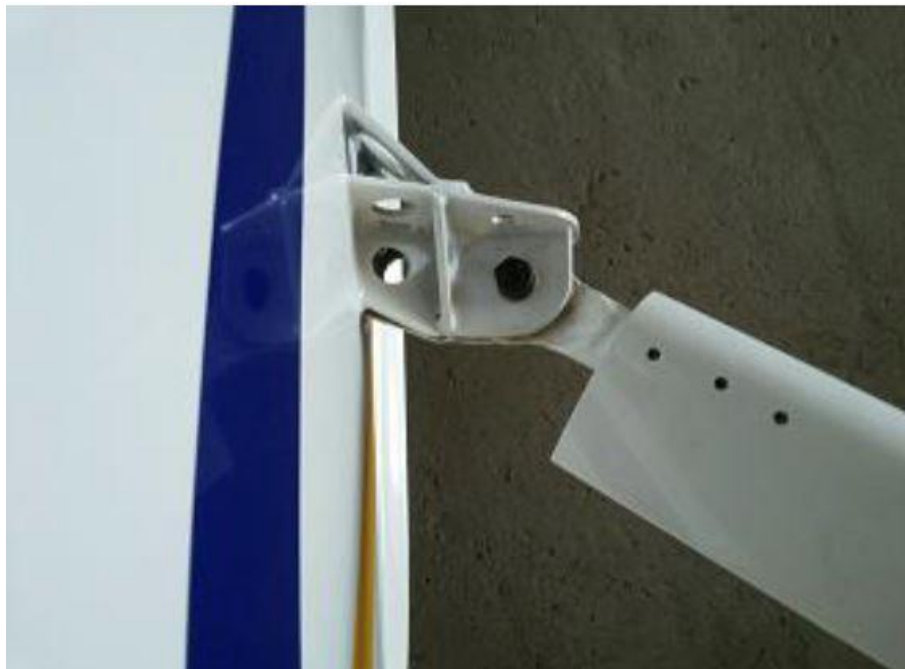
Foto 5: punto di attacco inferiore dell'asta di controventatura alla fusoliera (semiala destra).
