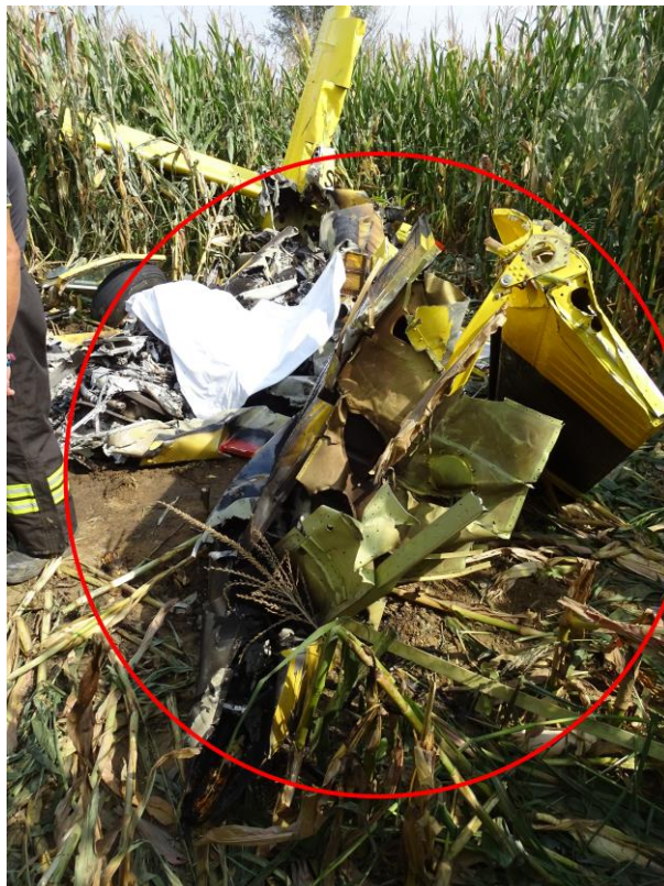
Foto 7: vista della parte principale del relitto. In primo piano, evidenziata dal cerchio rosso, l'estremità della parte di semiala rinvenuta nei pressi dell'aeromobile corrispondente ad una sezione del flap.
