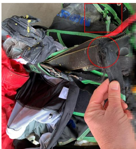
Foto 25: particolare della bretella sinistra anteriore del paracadute principale tranciata (nel cerchio rosso) e del contenitore del paracadute lacerato (nel rettangolo rosso), del quale un lembo è stato rinvenuto incastrato sul longherone superiore della semiala sinistra. L'imbragatura contenitore era un Vector Micron della United Parachute Technologies.
