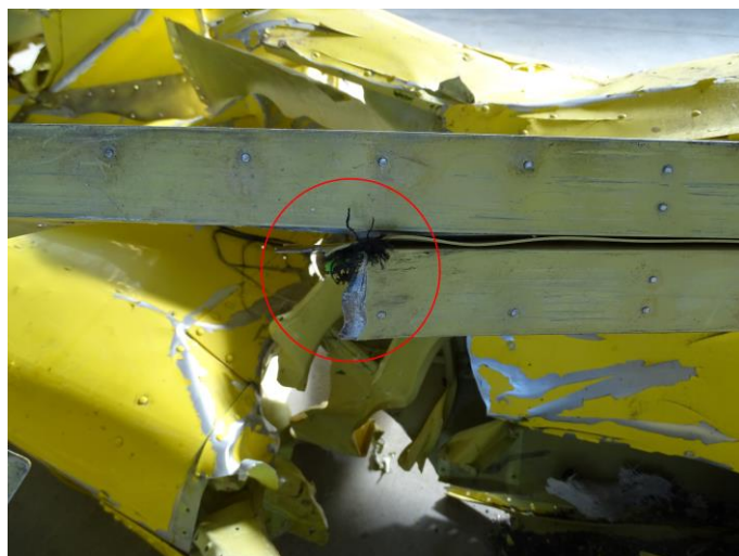
Foto 24: particolare del punto di frattura di una sezione di longherone superiore ove è rimasto incastrato un frammento del contenitore (tessuto nero e bordo verde) dal paracadute.
