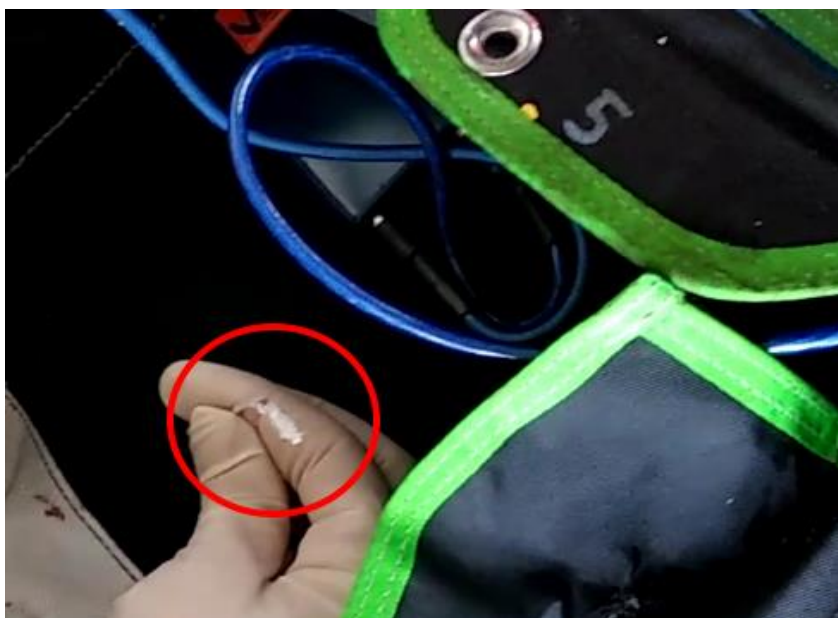
Foto 28: dettaglio del loop di chiusura del contenitore del paracadute di riserva, strappatosi a seguito della collisione.
