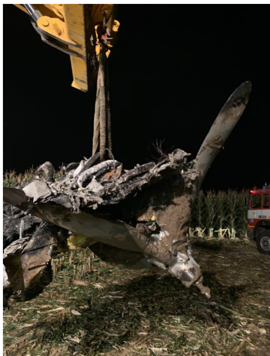
Foto 17: fase di estrazione del gruppo motopropulsore dal terreno.
