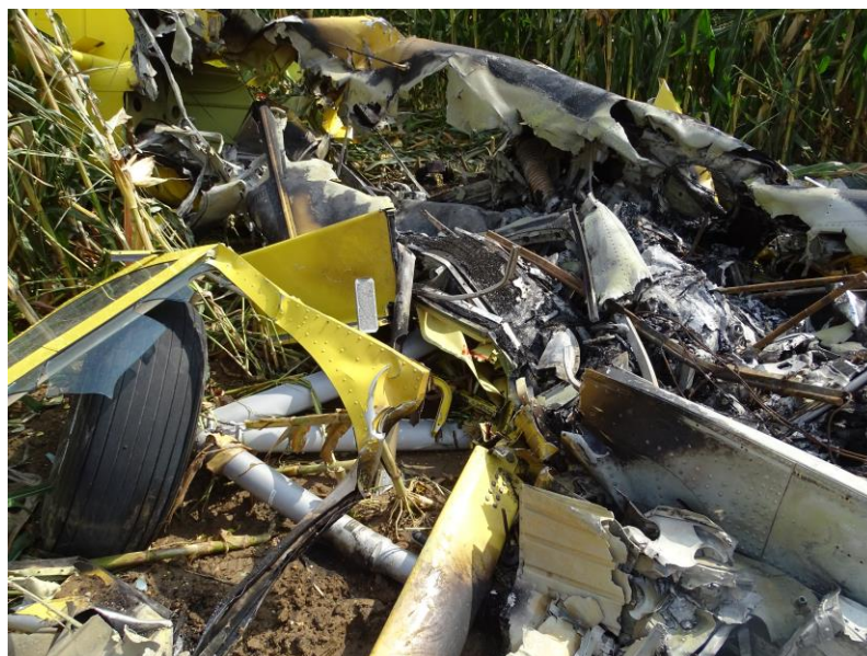
Foto 11: particolare dell'asta di controventatura della semiala destra.
