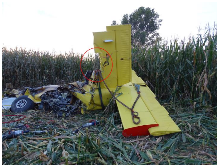
Foto 8: vista dei piani di coda. Evidenziata dal cerchio rosso la deformazione sul bordo di attacco della deriva, non riconducibile all'impatto con il suolo.
