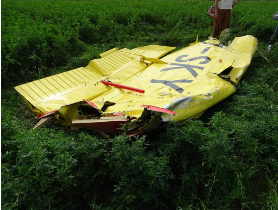
Foto 18: la parte principale della porzione di semiala sinistra (ventre della semiala rivolto verso l'alto), corrispondente alla sezione comprensiva dei due alettoni.
