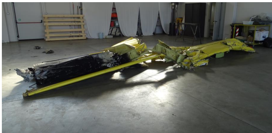
Foto 22: ricostruzione della semiala sinistra effettuata nel corso di un accesso al relitto.
