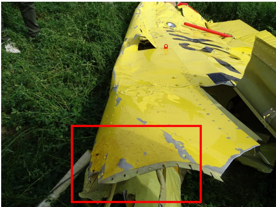
Foto 19: la parte principale della porzione di semiala sinistra (ventre della semiala rivolto verso l'alto) corrispondente alla sezione comprensiva dei due alettoni. In primo piano, evidenziato nel rettangolo rosso, il punto del bordo di attacco della semiala ove è avvenuto l'impatto con il paracadutista.
