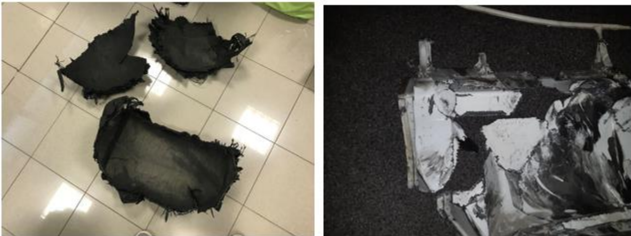
Parti di pneumatico rinvenute e particolare dei danni prodotti ai portelli del carrello principale destro.
