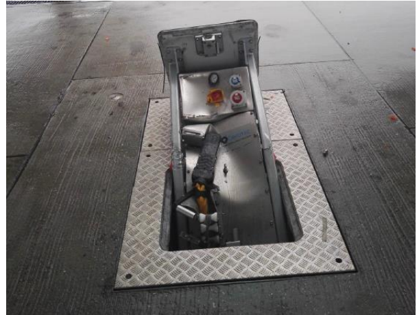
Danneggiamenti rispettivamente riportati dal carrello dell'A319 e dalla colonnina.
