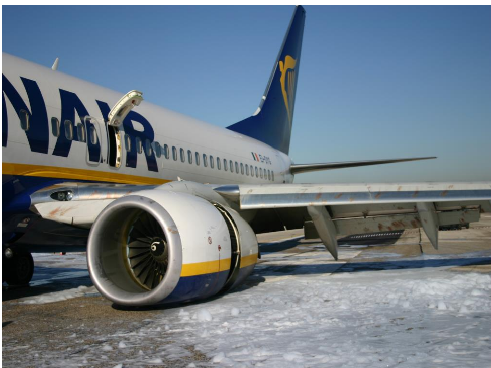
B737-8AS marche EI-DYG: notare le tracce degli impatti dei volatili.
