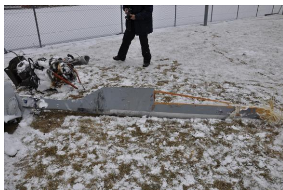
Foto 12: pala con sezione esterna mancante.
