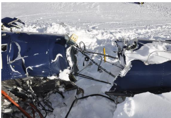
Foto 10: elicottero I-EDIC, distacco trave di coda.
