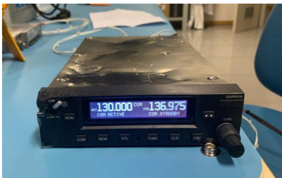
Foto 39: radio Garmin GTR 225A, prelevata dal relitto dell’I-EDIC, alimentata nel laboratorio ANSV.
