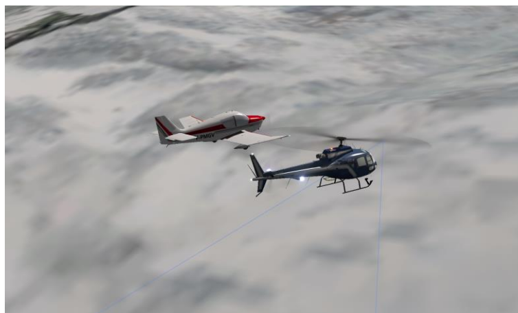
Figura 7: ricostruzione dell'impatto fra l'I-EDIC e il F-PMGV (animazione ANSV; per simulare il F-PMGV è stata utilizzata la sagoma di un aeromobile similare).
