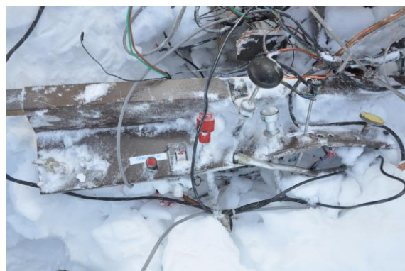
Foto 31: particolare comandi motore del F-PMGV.
