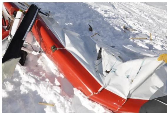
Foto 21: ventre semiala destra, con segni di vernice blu.
