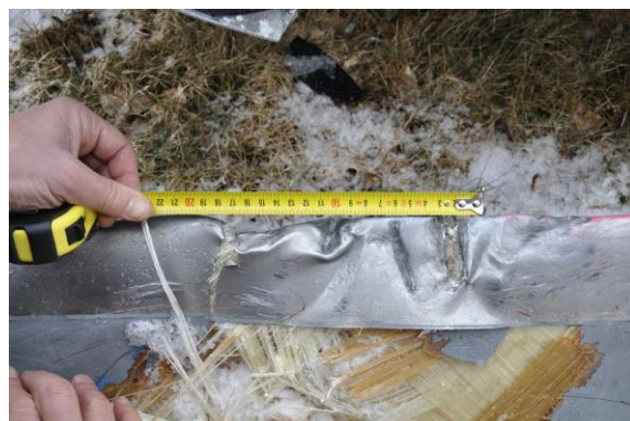
Foto 14: pala con deformazioni da impatto oggetto metallico.
