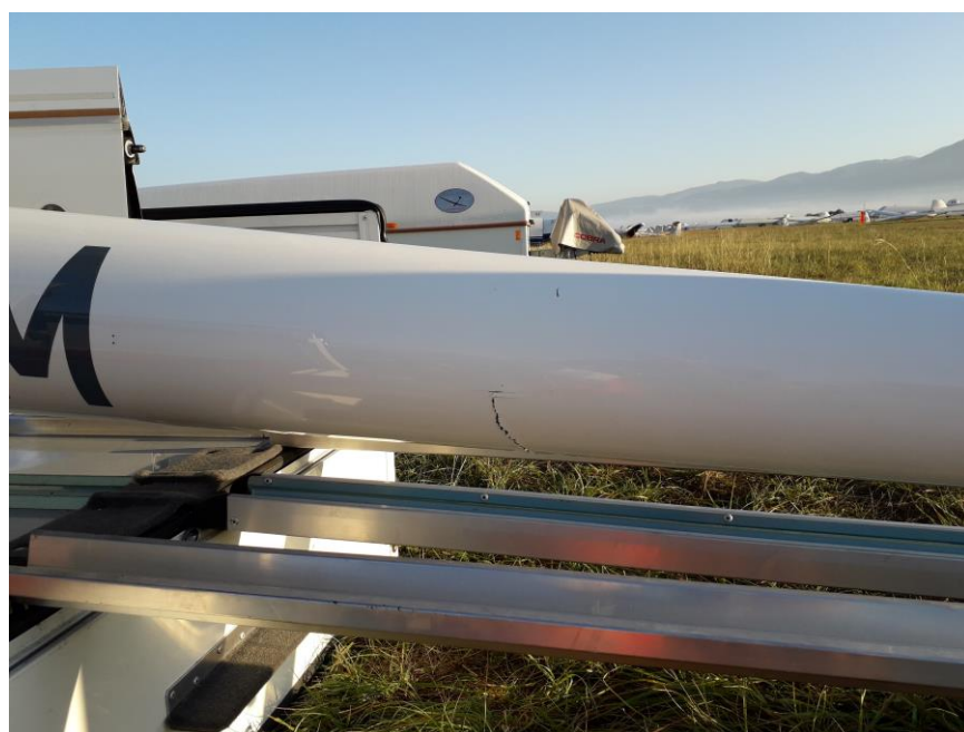
Foto 2: primo piano del danno riportato in fusoliera dal D-KGCM.
