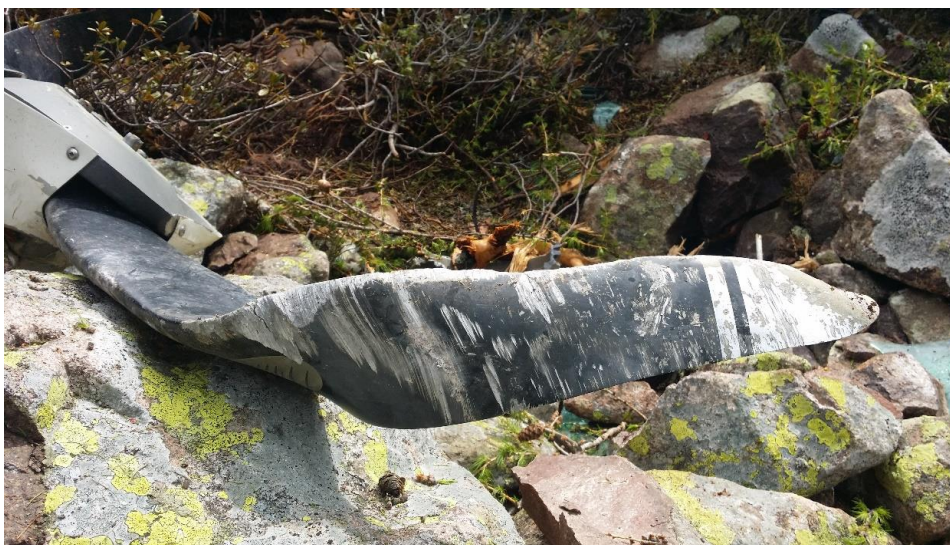
Foto 5: danneggiamenti di una pala dell'elica.
