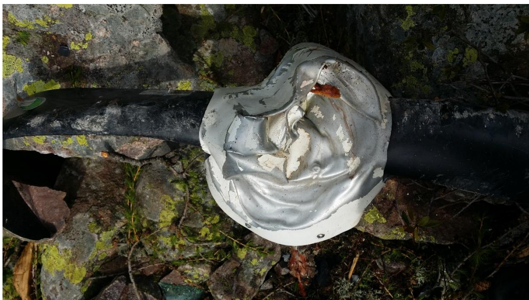
Foto 4: danneggiamenti ogiva dell'elica.
