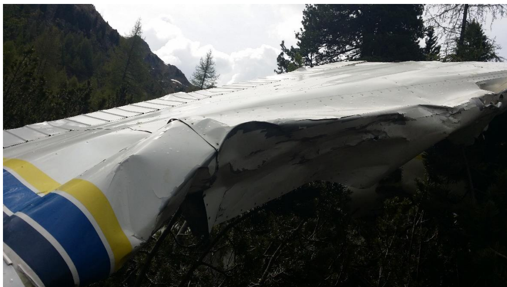
Foto 3: danneggiamenti semiala destra.
