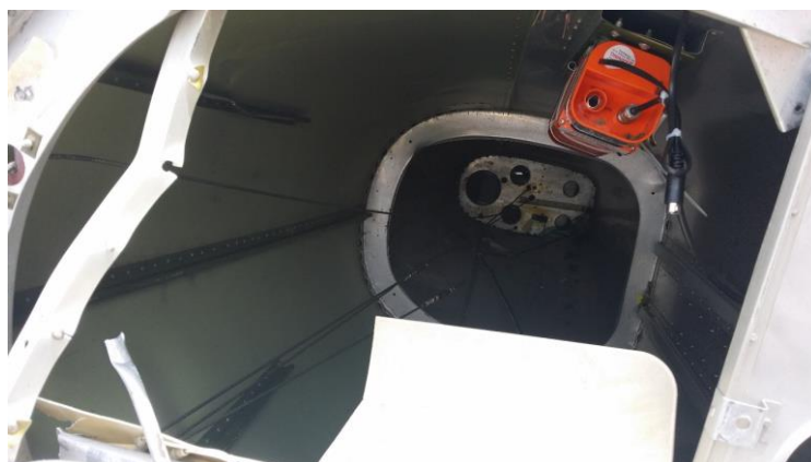
Foto 10: interno del trave di coda con l'ELT.
