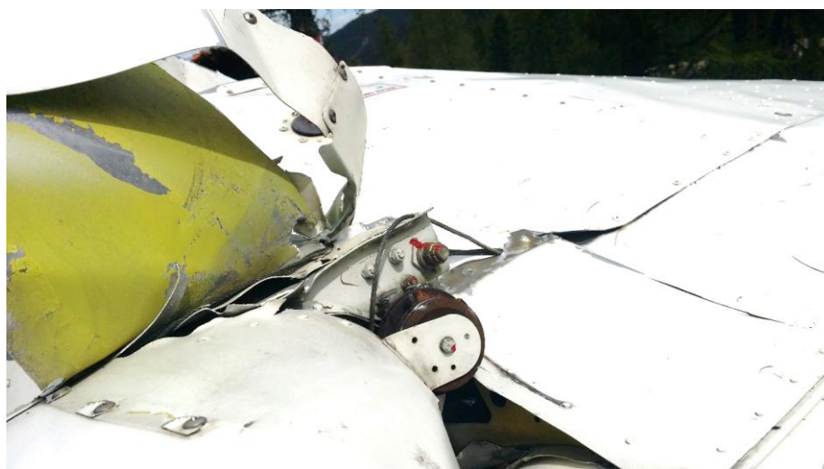
Foto 14: cavi e puleggia di rimando comandi semiala destra.
