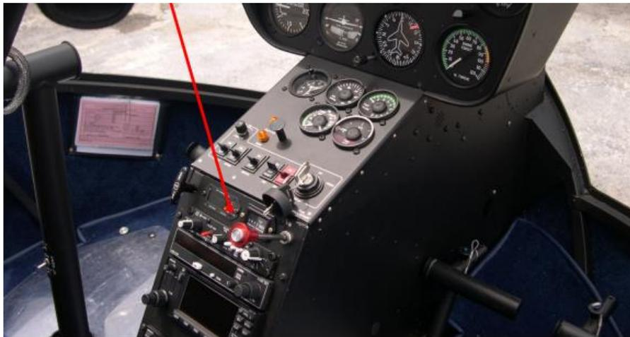
Foto 2: indicato dalla freccia rossa su modello di elicottero analogo il comando fuel cut off in posizione estratta (cut off).
