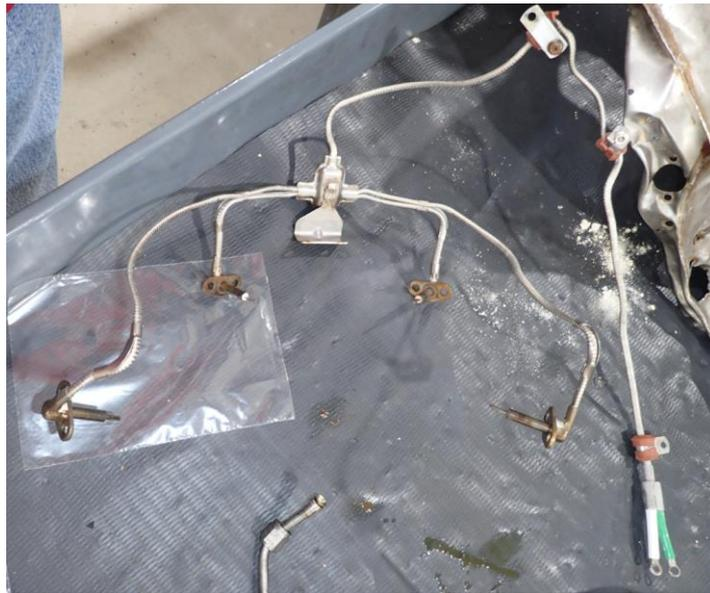
Foto 46: termocoppie e cablaggio rimossi dalla sezione della turbina.
