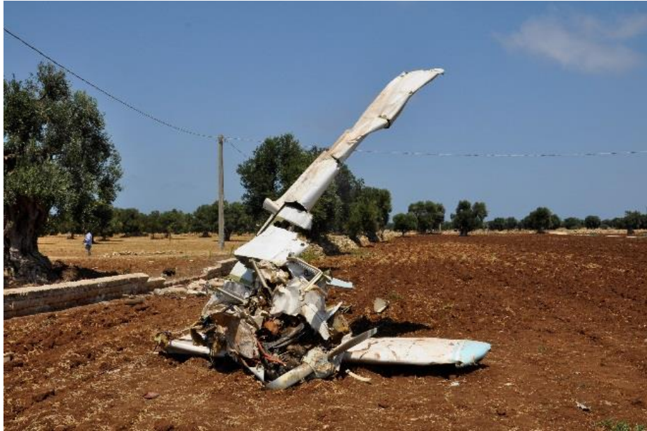
Il relitto del velivolo Piper PA-28 marche I-SVBA nel luogo dell'incidente.
