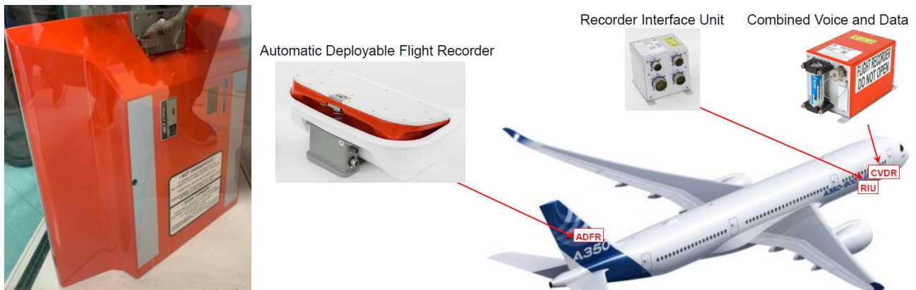
A sinistra, esempio di ADFR. A destra, esempio di installazione dell'ADFR (fonte Airbus Industrie).
