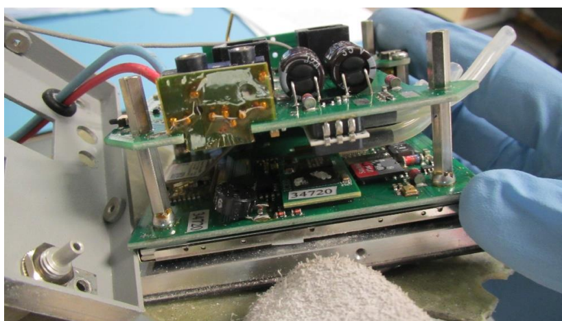
Esempio di attività tecnica per l'estrazione memoria dati da unità avionica non protetta.
