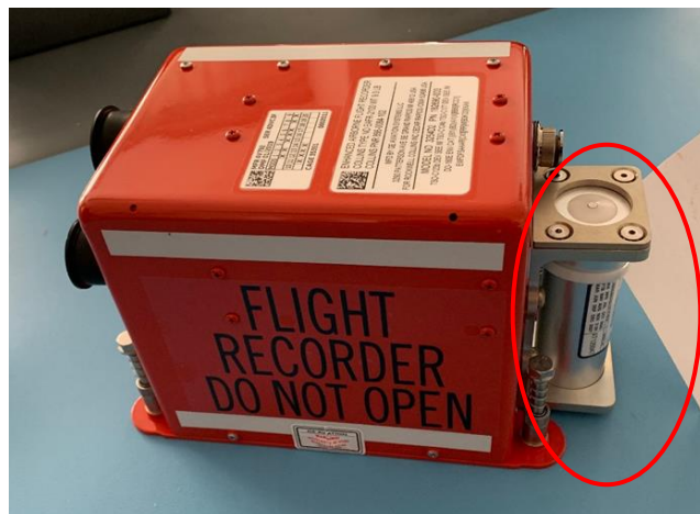
Un apparato combinato EAFR, già presente sui Boeing 787. In evidenza, sulla destra l'ULB.
