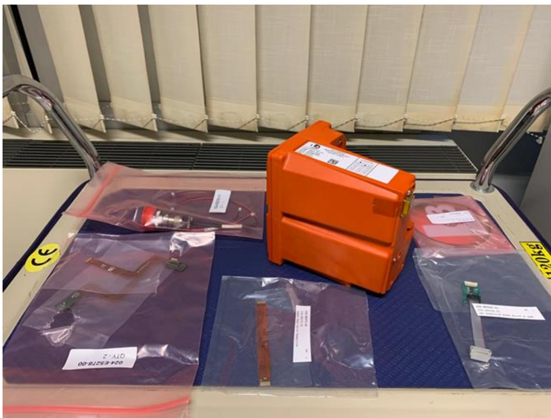
Kit di estrazione dati per i registratori della serie FA5X00 prodotti dalla L3Harris, acquisito nel 2021 dall'ANSV.
