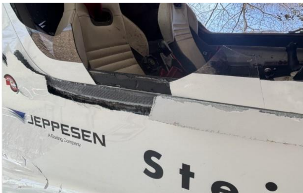
Foto 7: frammento in plexiglas del canopy , lato destro della cabina dell'aeromobile.
