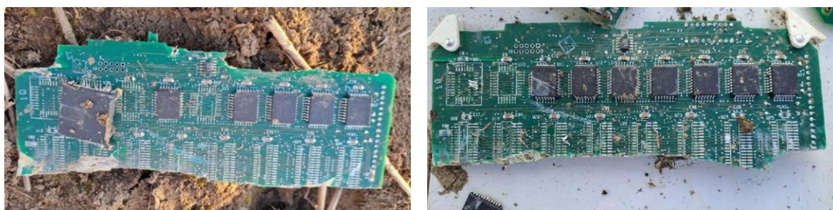
Foto 7 e foto 8: schede elettroniche della DAU a seguito dell'incidente.
