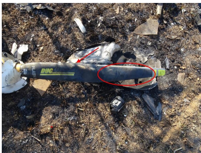
Foto 7: particolare della pala fratturata a circa un terzo della lunghezza (punto evidenziato dalla freccia).
