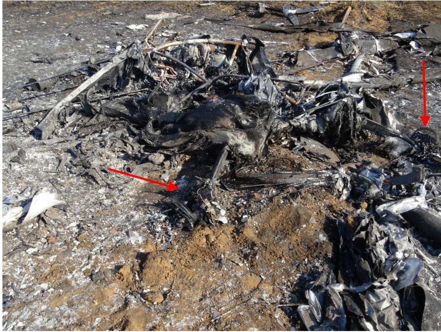
Foto 12: vista del carrello principale
