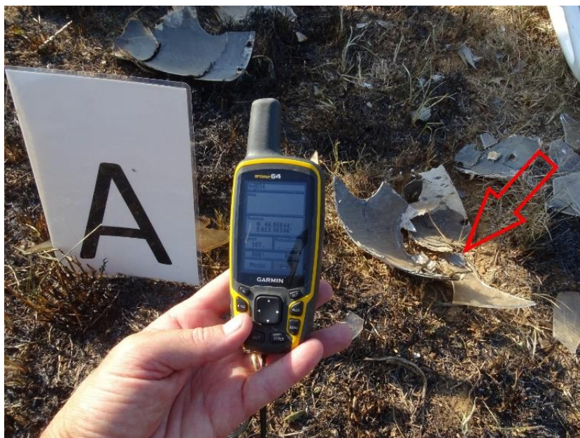
Foto 4: particolare del punto di impatto dell'ogiva dell'elica.
