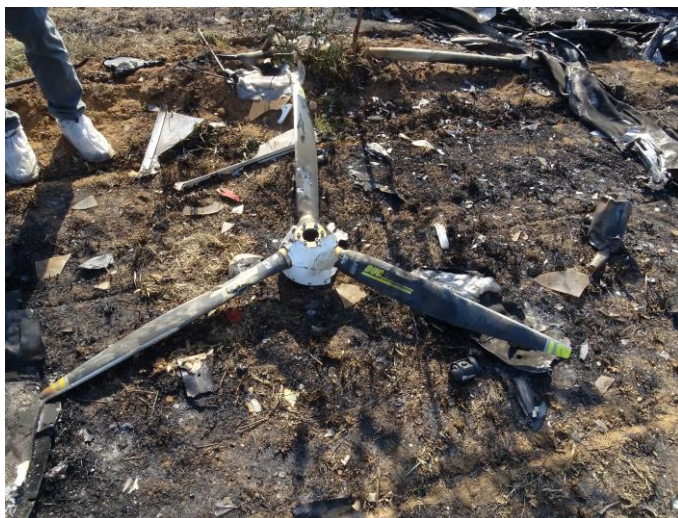
Foto 6: vista frontale dell'elica tripala.
