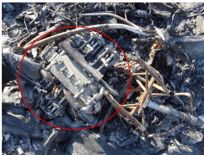
Foto 11: il motore Rotax 912 ULS 100 CV.
