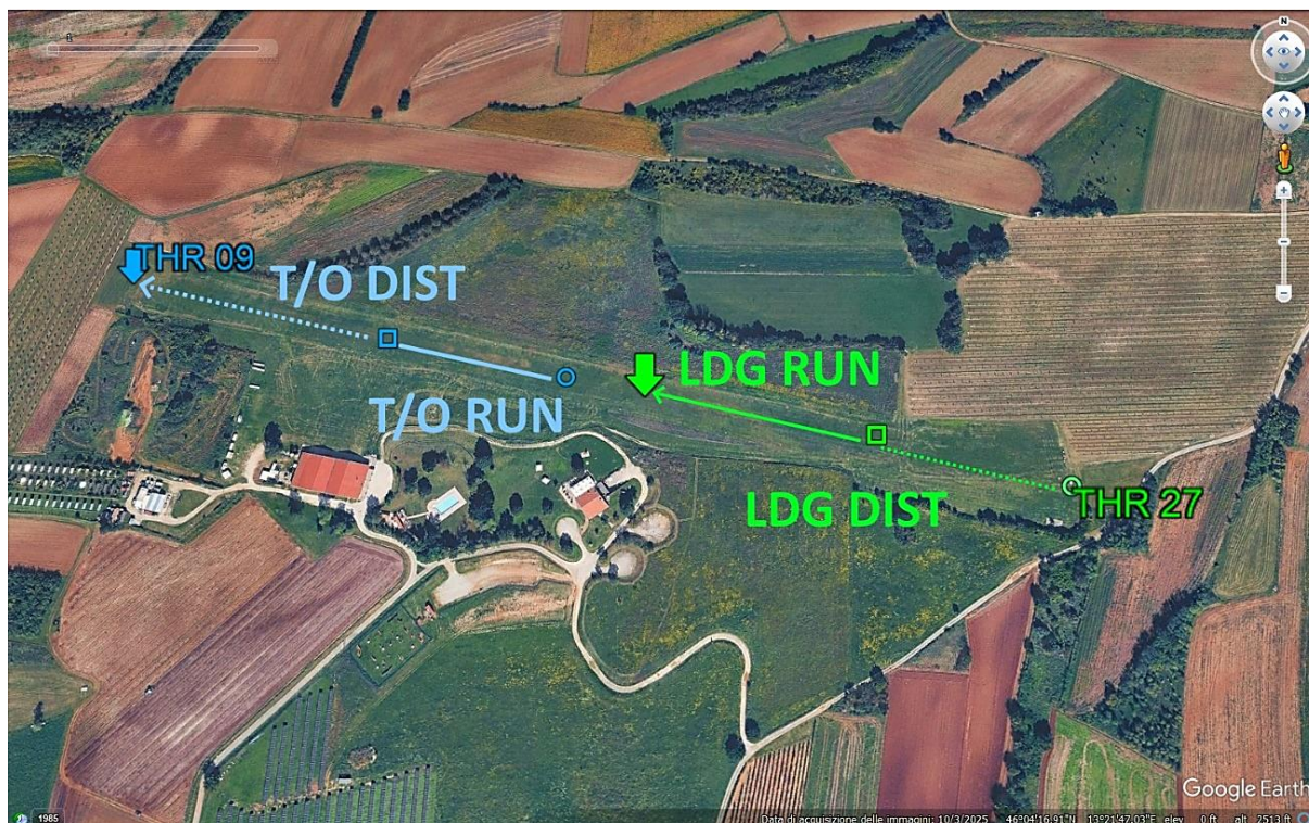
Figura 3: Landing Distance (linea tratteggiata + continua in verde) tracciata a partire dalla THR27 (pista utilizzata per l'atterraggio dal velivolo I-E214) e Take-off distance.
