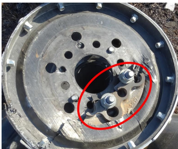
Foto 9: vista posteriore dell'elica tripala con evidenza della porzione di flangia rimasta solidale all'elica.
