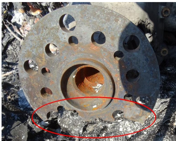
Foto 10: vista della flangia d'attacco dell'elica al motore. Evidenziata la parte fratturata, con parte mancante rimasta solidale all'elica.
