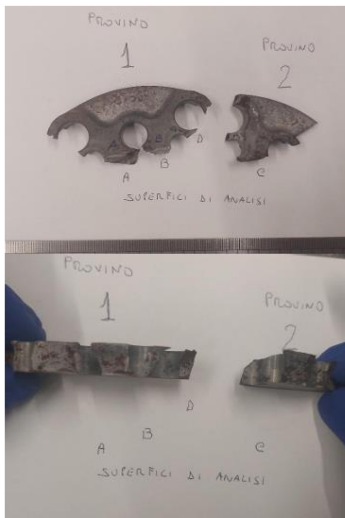
Foto 17: vista in pianta e vista laterale del campione oggetto di indagine.
