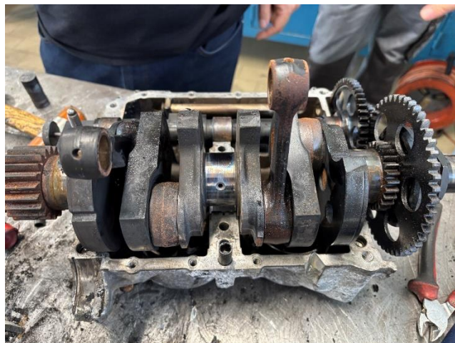
Foto 16: vista dell'interno del motore dopo la separazione dei semi carter.
