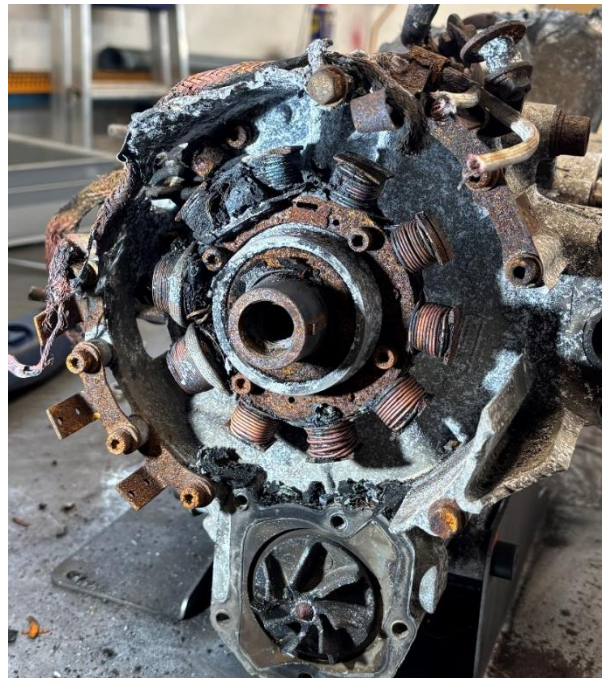
Foto 15: vista della parte posteriore del motore. Generatore della corrente del sistema di accensione (sopra) pompa del liquido di raffreddamento (sotto).
