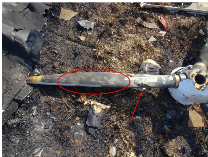
Foto 8: particolare della pala fratturata a circa un quarto della lunghezza (punto evidenziato dalla freccia).
