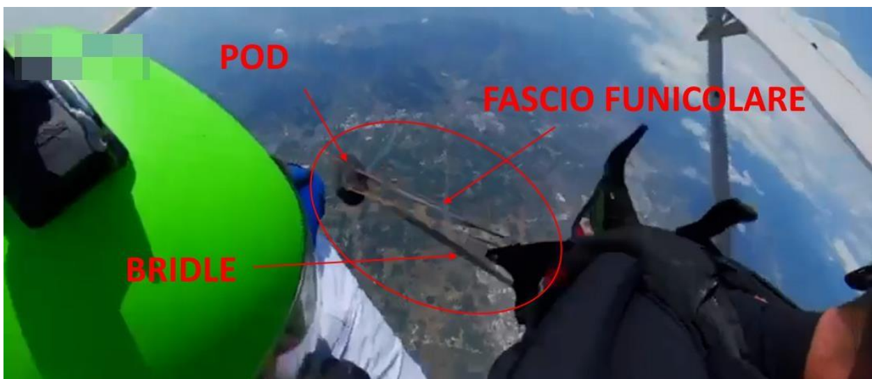
Foto 7: fotogramma della fase di uscita dalla sacca contenente la velatura del paracadute principale (POD). Si nota la distensione del fascio funicolare e della fettuccia di collegamento (bridle) tra il paracadute principale ed il pilotino estrattore (hand deploy) che pertanto risulterebbe ancora in sede.
