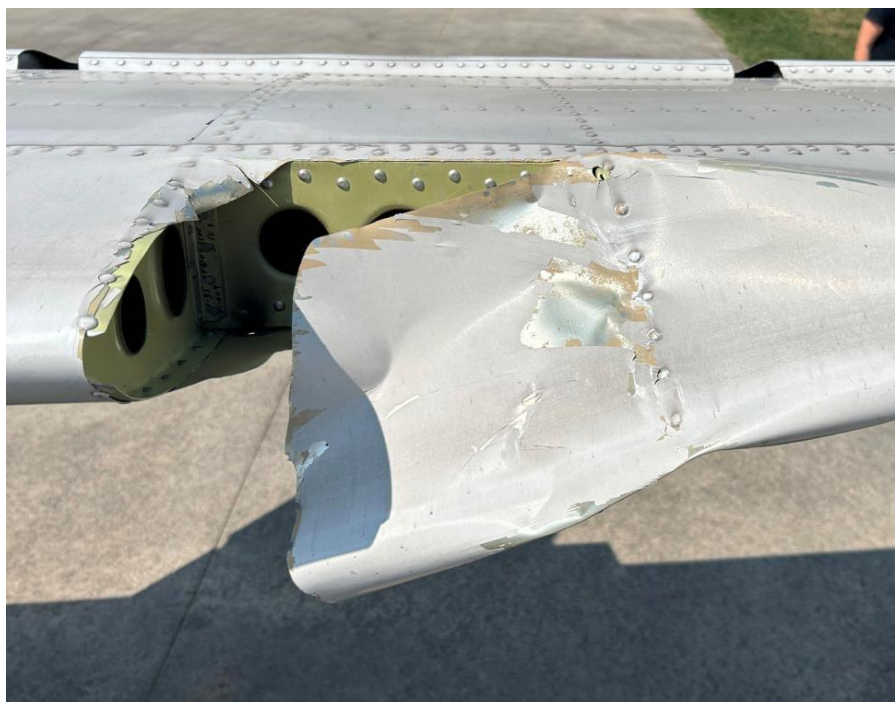
Foto 2: danno al bordo di attacco dello stabilizzatore.
