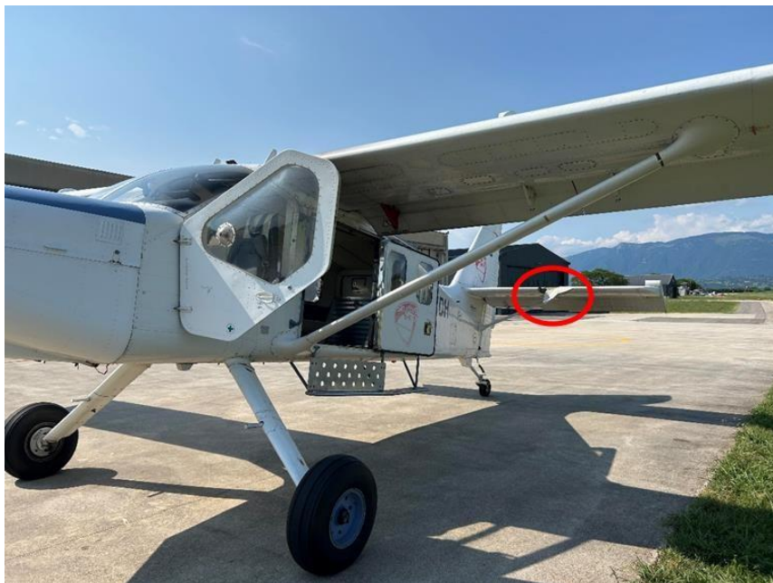
Foto 1: velivolo SMG-92 Turbo Finist con marche HA-YDH. Nell'ovale rosso evidenziato il punto di impatto ed il conseguente danno al bordo di attacco dello stabilizzatore.
