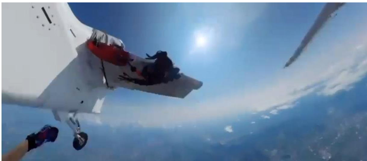
Foto 10: fotogramma che evidenzia la fase di impatto del paracadutista con lo stabilizzatore sinistro.
