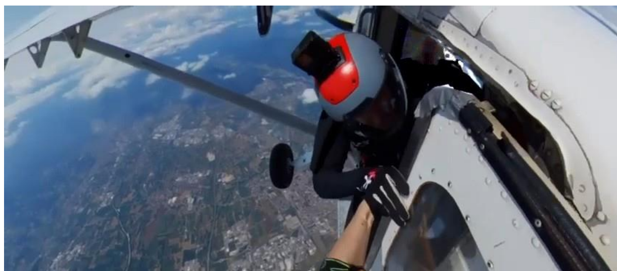
Foto 5: fase di posizionamento all'esterno dell'aeroplano del paracadutista istruttore. Si nota la rotazione in senso antiorario per l'uscita dalla porta che espone il paracadute al vento relativo e ad alla potenziale interferenza con il montante anteriore della porta.
