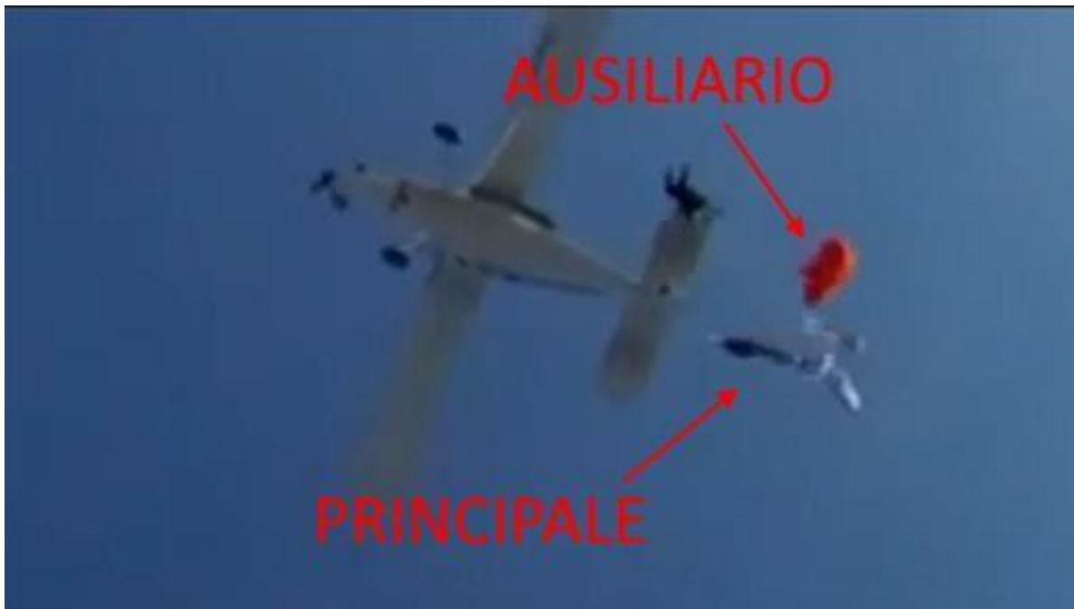
Foto 12: fase dello sgancio della velatura principale (scura) ed apertura del paracadute ausiliario (arancione).
