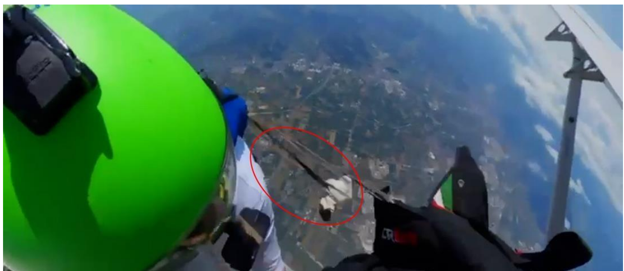
Foto 8: fuoriuscita del pilotino estrattore (hand deploy) evidenziato nell'ovale rosso.
