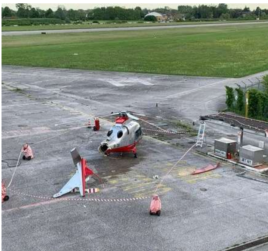
Foto 1: posizione di arresto finale dell'elicottero. Sono visibili i danni all'elicottero e alla pensilina.
