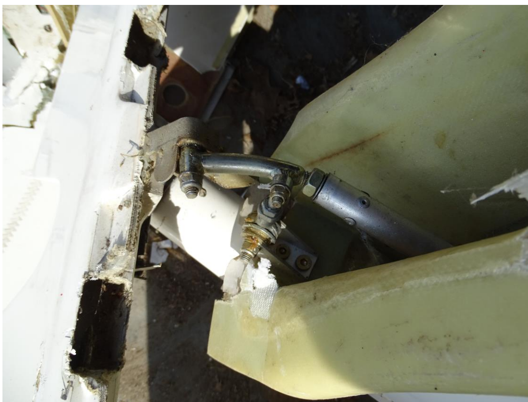
Foto 7: linea di comando dell'elevatore.
