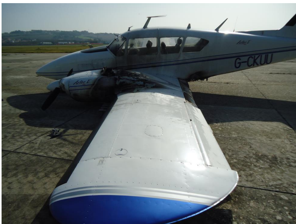
Foto 2: i danni riportati al motore sinistro del PA-23-250 marche G-CKUU.
