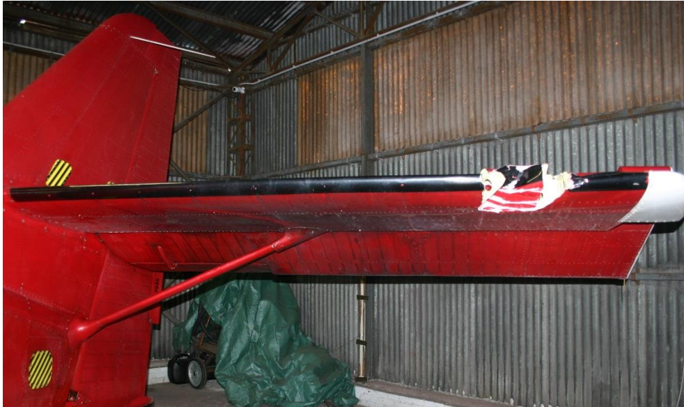
Foto 5: danno provocato dall'impatto del portellone sul bordo d'attacco dello stabilizzatore sinistro.
