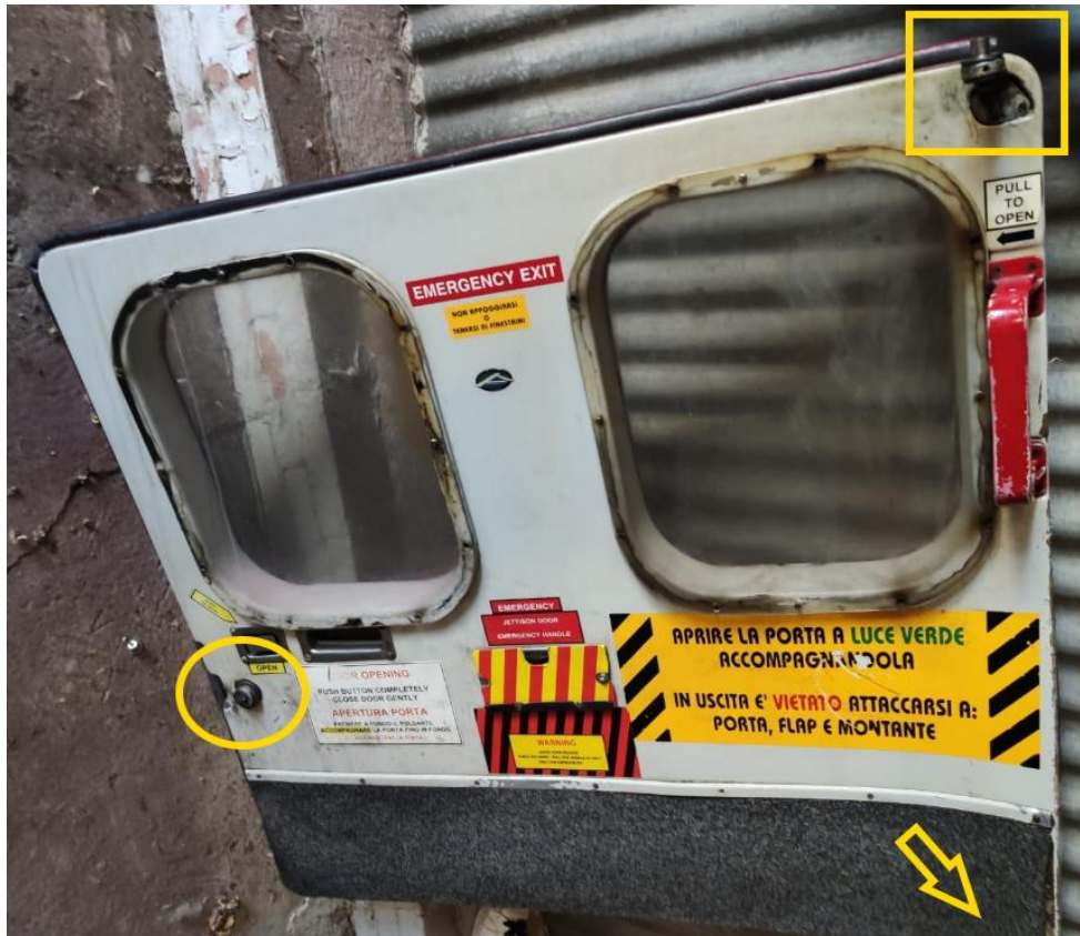
Foto 6: il portellone dopo il recupero. Nel riquadro giallo è evidenziato il perno, integro, del sistema di scorrimento del portellone stesso nella guida superiore; nel cerchio è evidenziato il punto di attacco alla guida centrale; la freccia indica il punto di fissaggio del cilindro di sblocco in emergenza al sistema di scorrimento del portellone nella guida inferiore.
