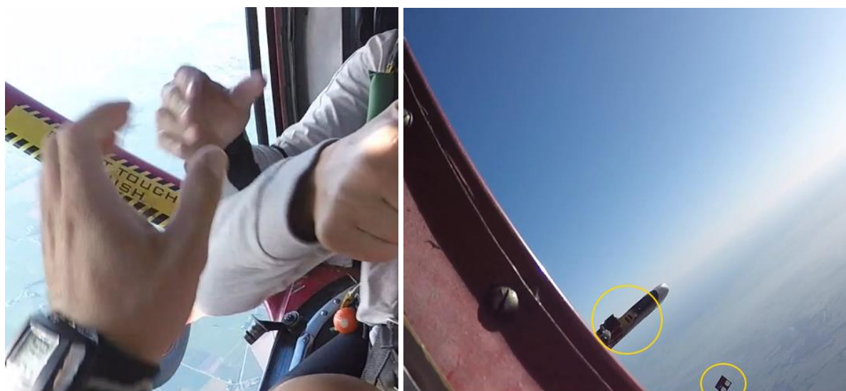
Foto 3 e 4: fotogrammi tratti dal video della telecamera di un paracadutista. A sinistra, si nota il sistema di scorrimento del portellone nella guida inferiore separatosi in corrispondenza del cilindro di sblocco in emergenza; a destra, si possono vedere la caduta del portellone e il danno al bordo di attacco dello stabilizzatore sinistro.
