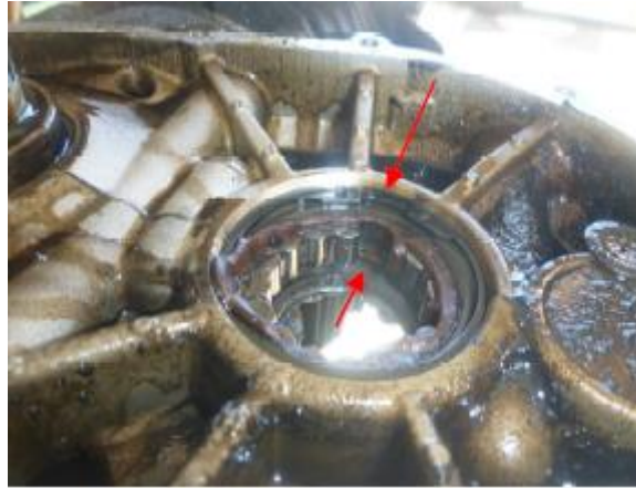
Foto 22: danneggiamento dovuto al calore del cuscinetto di supporto.
