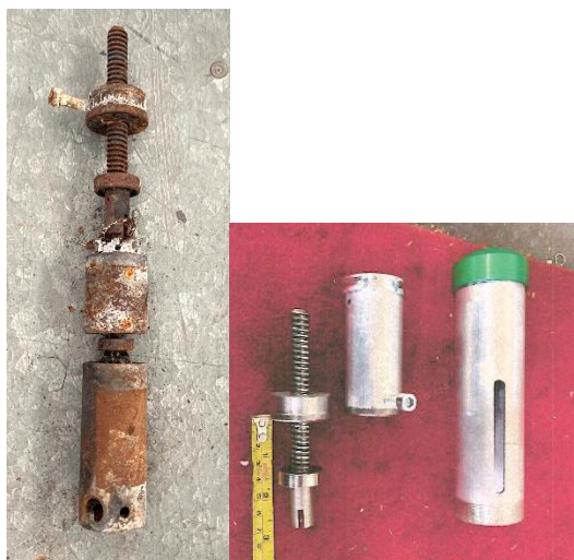
Foto 29: attività di confronto tra pompa nuova e proveniente dal relitto dell'I-8548.
