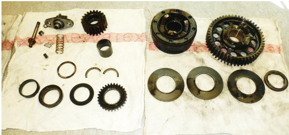
Foto 23: elementi costituenti la gearbox elica.
