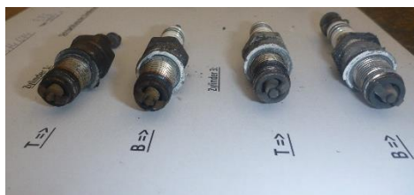
Foto 25: candele cilindri 1 e 3.
