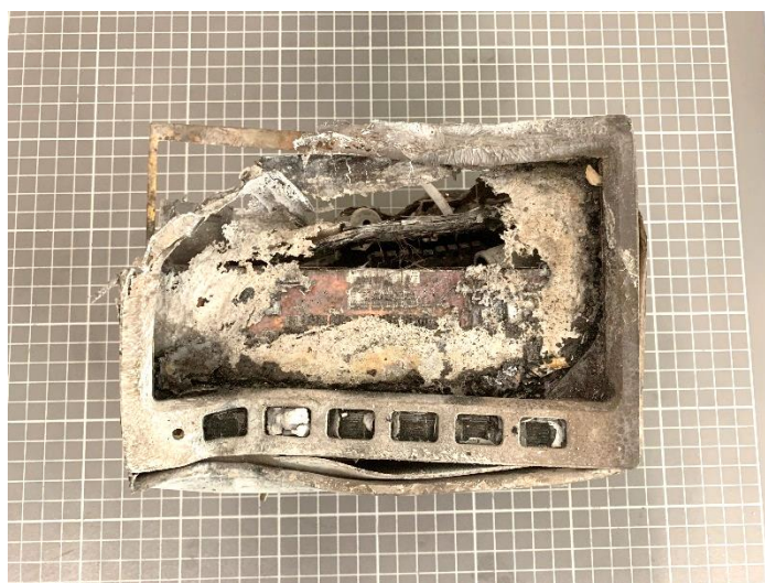
Foto 13: Dynon EFIS D100, danneggiamenti. Vista frontale.
