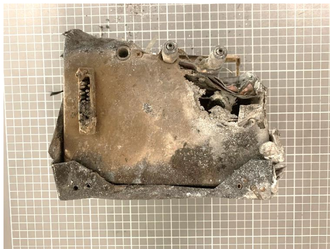
Foto 14: Dynon EFIS D100, danneggiamenti. Vista posteriore.
