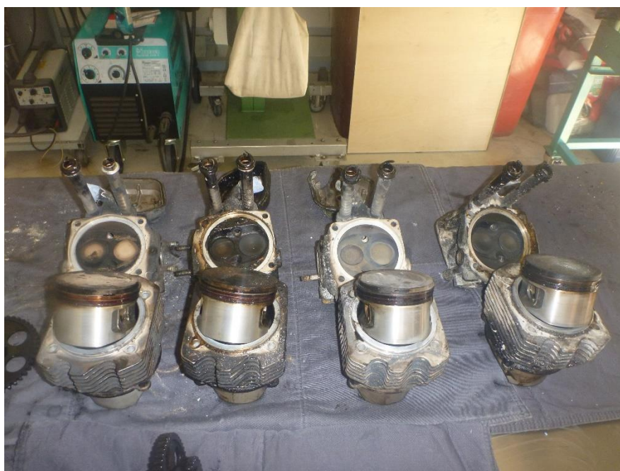
Foto 27: ispezione cilindri, testate, valvole pistoni.
