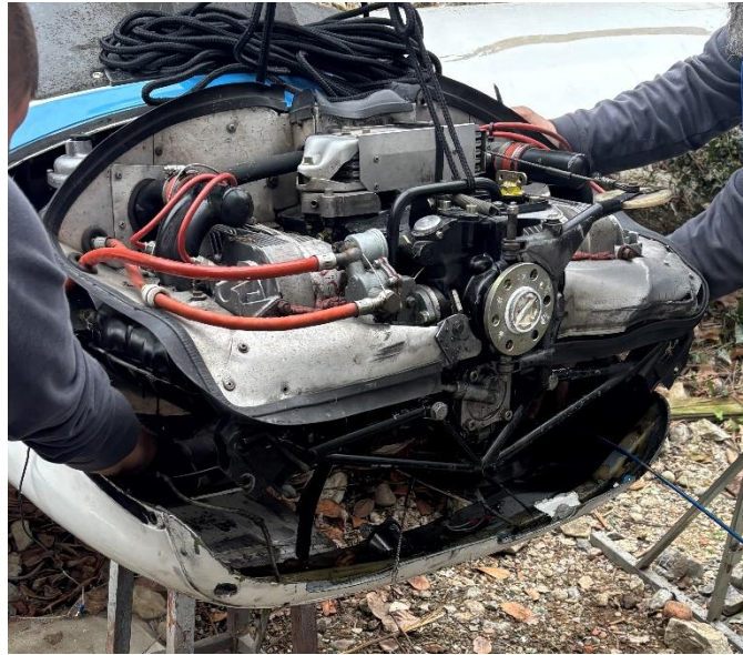
Foto 21: propulsore in fase di rimozione per ispezione.
