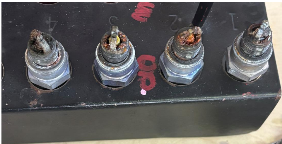
Foto 22: candele rimosse dal motore dell'I-ILMA. Al netto dei fenomeni ossidativi, le candele si sono mostrate in buone condizioni.
