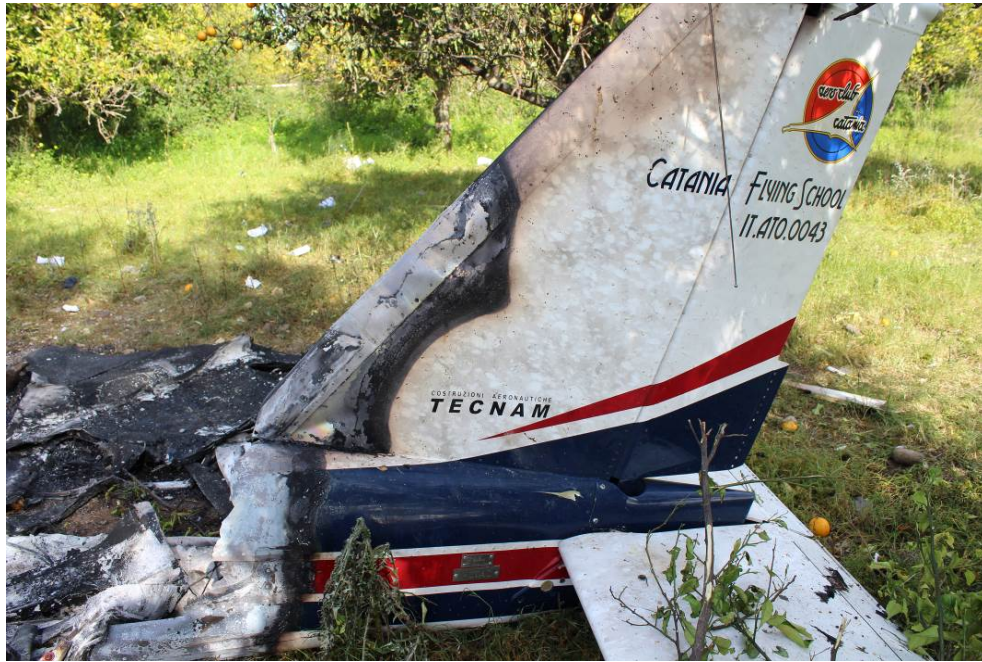
Foto 5: dettaglio posizione timone.
