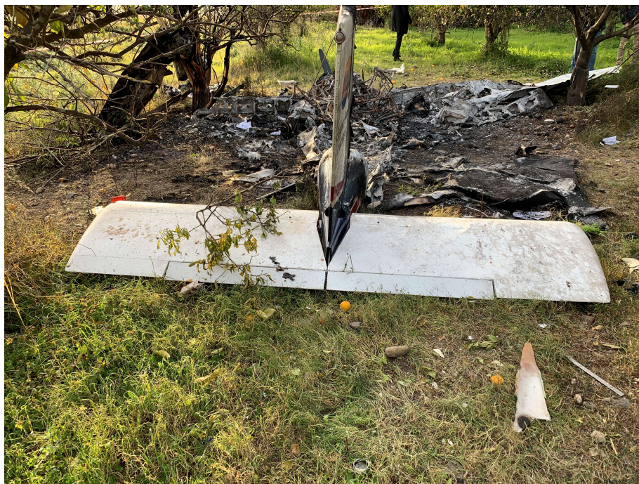
Foto 6: piani verticale ed orizzontale di coda.
