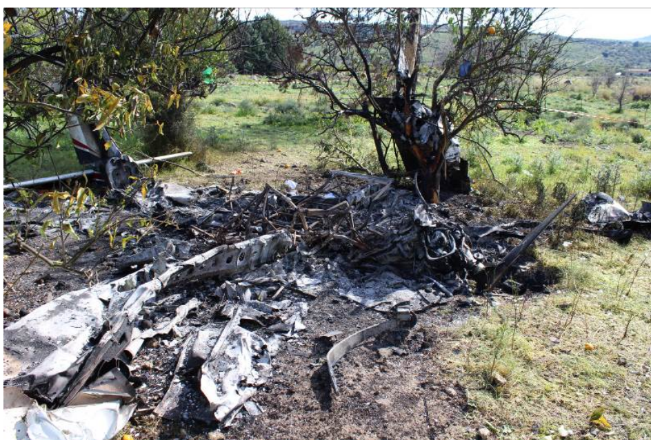
Foto 4: dettaglio longherone semiala destra.
