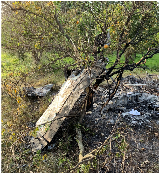
Foto 3: Tecnam P2002-JF marche I-CTAC dopo l'incidente, semiala sinistra in primo piano.
