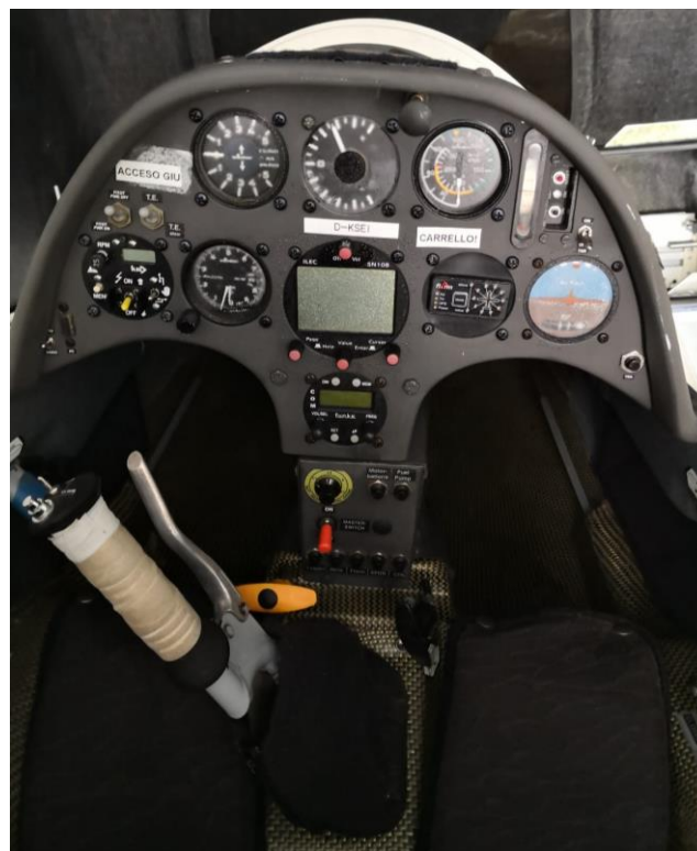
Foto 3: cruscotto del posto di pilotaggio anteriore dall'aliante D-KSEI (è visibile la manopola gialla del comando di sgancio traino).
