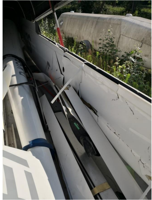
Foto 1 e 2: danneggiamenti riportati dall'aliante D-KSEI.
