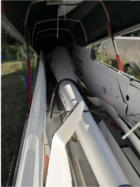
Foto 1 e 2: danneggiamenti riportati dall'aliante D-KSEI.
