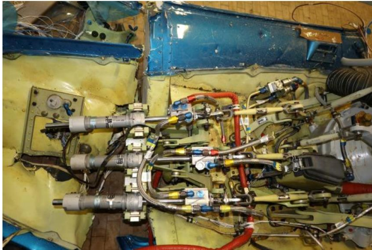
Foto 7: dettaglio dei tre servo attuatori del rotore principale.
