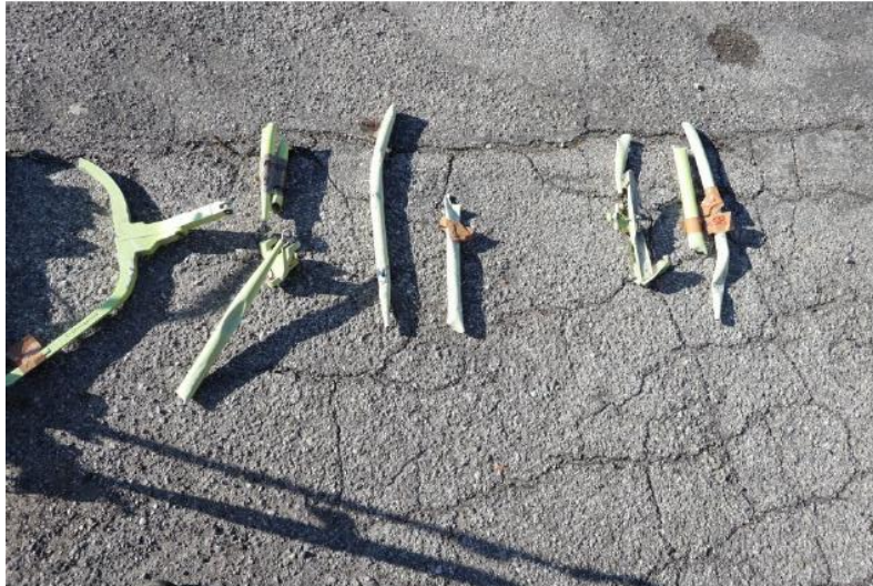
Foto 3: porzioni della linea dei comandi di volo con fratture da sovraccarico in area corrispondente alla sezione della struttura maggiormente danneggiata dall'impatto.
