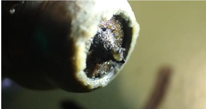
Foto 36: rivelatore chip inferiore, con presenza di depositi non metallici in seguito all'esposizione all'acqua.
