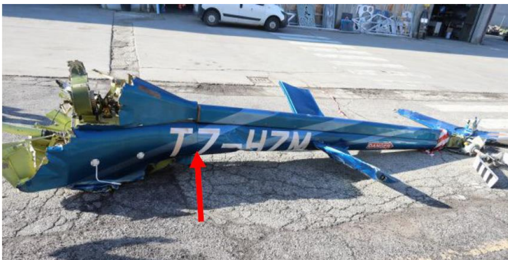
Foto 26: sezione fratturata della fusoliera posteriore con boom di coda attaccato. La freccia indica l'interfaccia.
