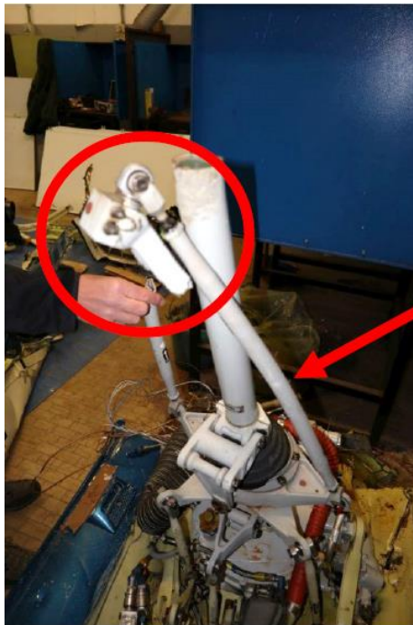
Foto 8: pitch link pala rossa, asta collegata a piatto oscillante ed a pitch horn fratturato.
