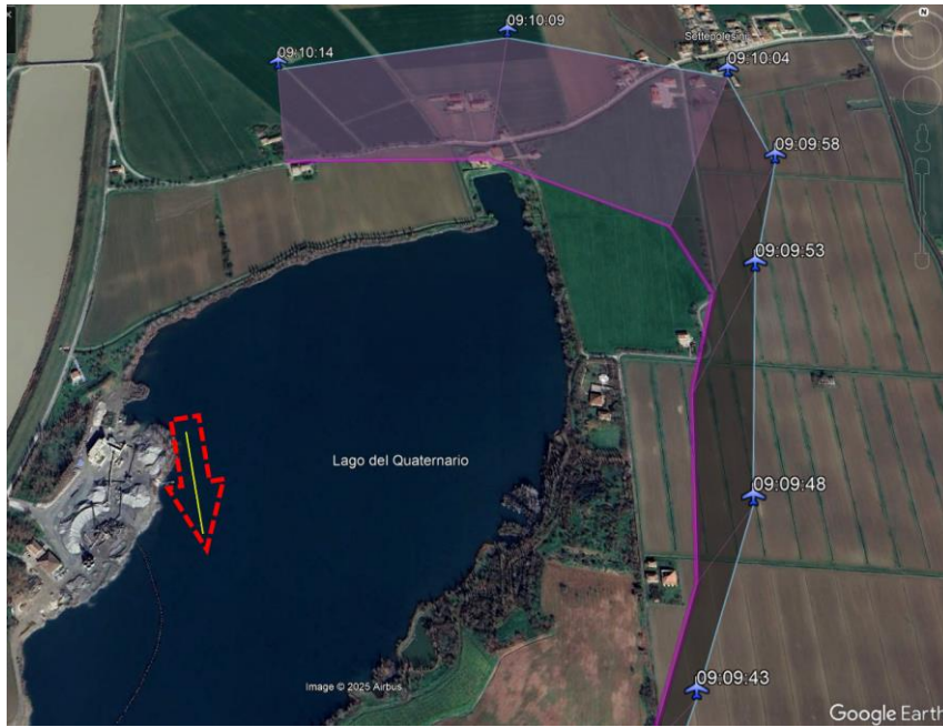
Figura 6: trasposizione su Google Earth del tracciato radar degli ultimi 30 secondi di volo. La freccia indica la direzione della dispersione dei rottami.
