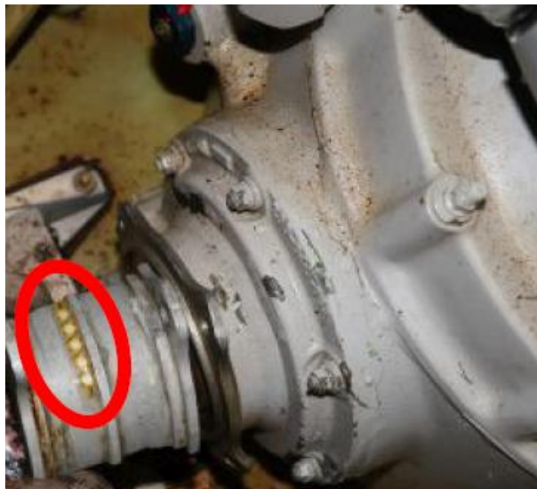
Foto 16: sezione fratturata dell'accoppiamento esterno dell'albero di trasmissione principale con punti temporanei bianchi (ovali).
