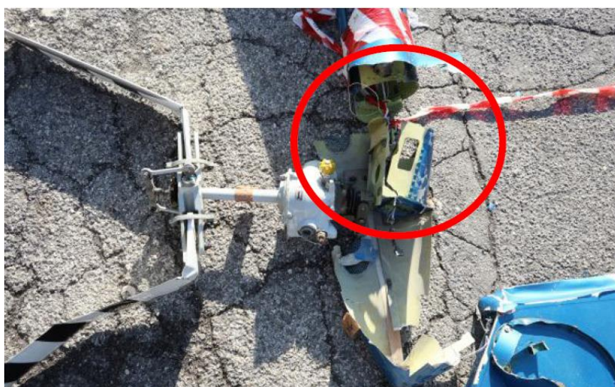
Foto 27: frattura del supporto della scatola del rotore di coda all'estremità posteriore del boom di coda (cerchio).
