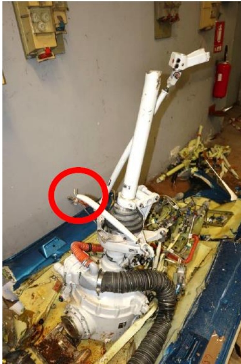
Foto 9: pitch link pala bianca, asta fratturata, clevis inferiore ancora collegato al piatto oscillante.
