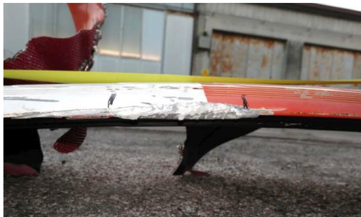
Foto 21: abrasione sul bordo d'attacco della pala del rotore bianca.
