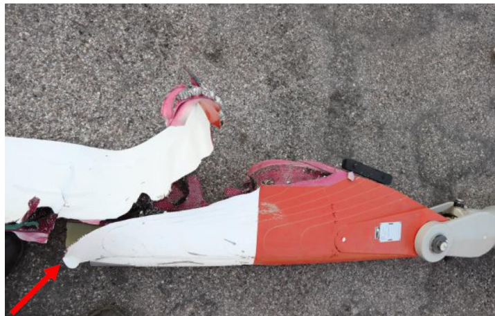
Foto 20: frattura del longherone della pala del rotore principale bianco appena fuori dal rinforzo più esterno (freccia).
