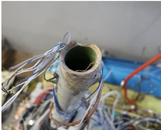
Foto 12: rottura e piegatura dell'albero appena al di sotto dell'area di contatto dei fermi statici.
