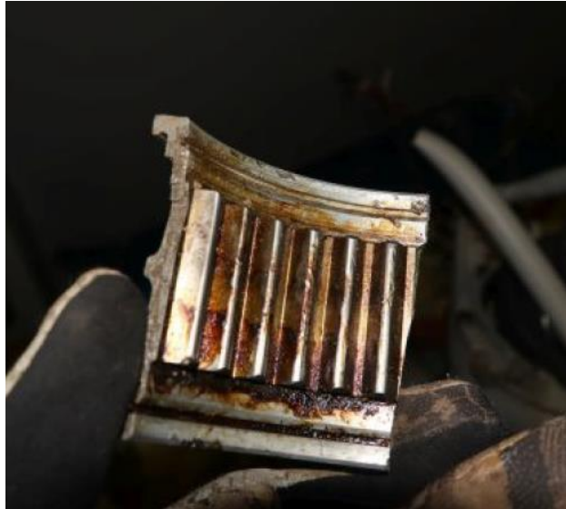
Foto 15: sovraccarico del giunto esterno della trasmissione anteriore con frattura in circa \frac{1}{4} della sezione. Scanalature del giunto intatte.
