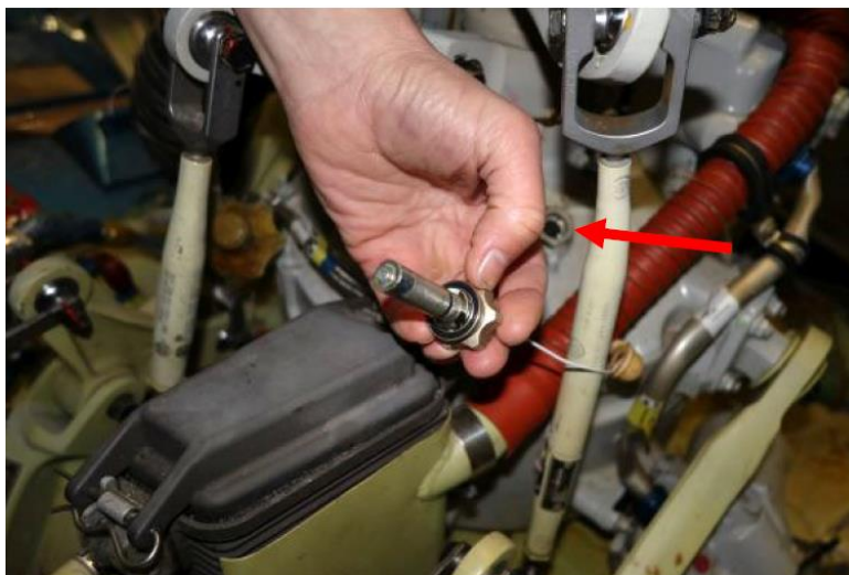
Foto 14: nessun frammento sul rilevatore di frammenti superiore della trasmissione principale. La freccia indica la posizione di installazione.
