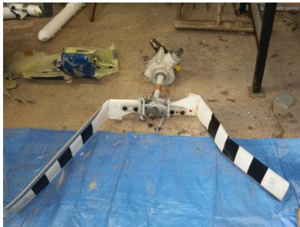
Foto 29: mozzo del rotore di coda con entrambe le pale che presentano curvature in corrispondenza dei punti interni.
