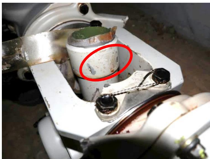
Foto 13: segno di contatto sull'albero (ovale) causato dal contatto statico della testa del rotore principale.
