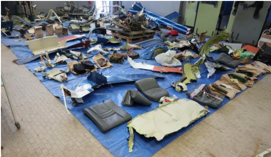
Foto 24: l'elicottero è stato gravemente danneggiato dall'impatto con l'acqua.
