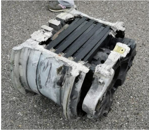
Foto 11: ruota 1 e relativo ceppo freno.
