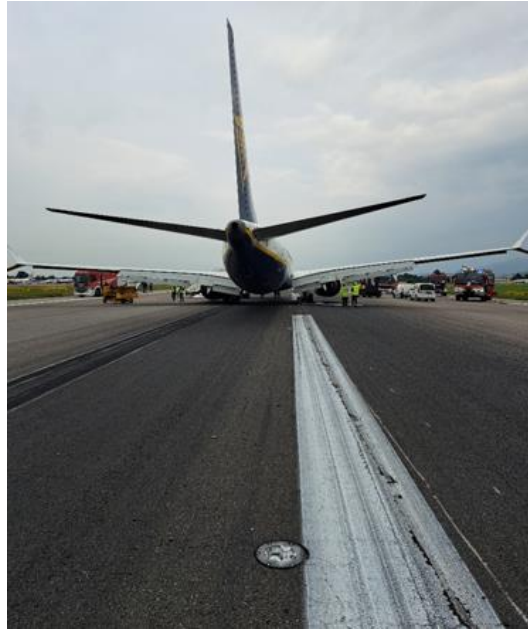
Foto 6: area della pista, in prossimità dell'aeromobile, interessata da danni e detriti (Fonte: SACBO).
