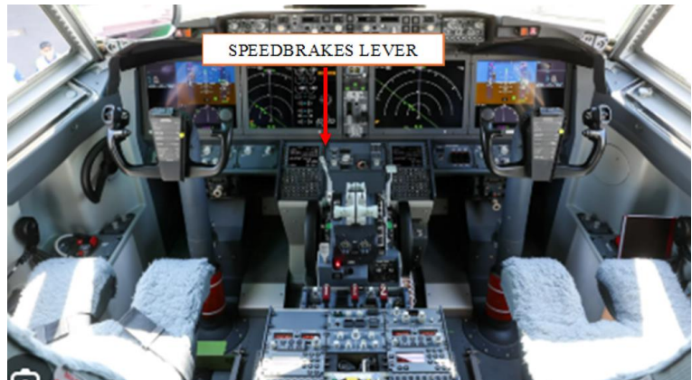
Figura 3: posizione degli speedbrakes nel cockpit (immagine copyright della società Boeing. Riprodotta su autorizzazione).
