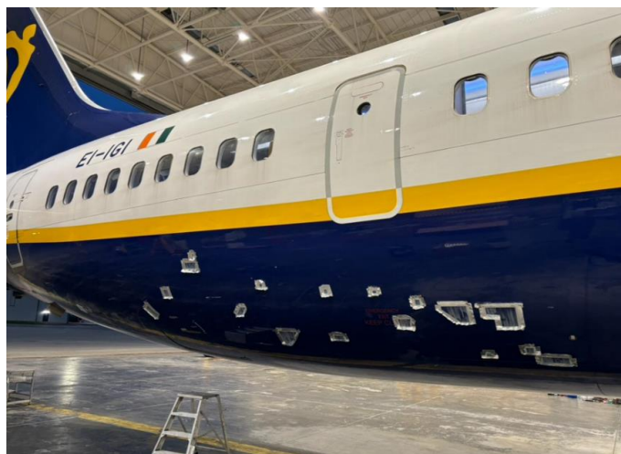
Foto 19: danneggiamenti sulla fusoliera lato destro.
