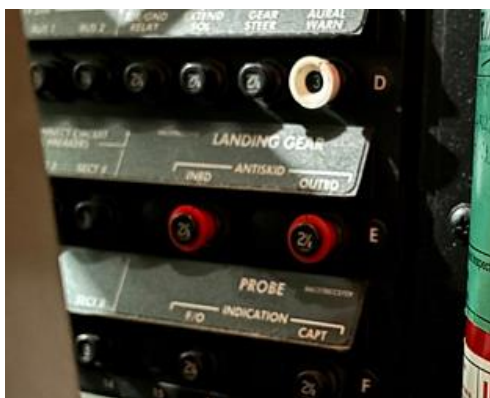
Foto 22: dettaglio estrazione e protezione, tramite "collarino", degli interruttori ANTISKID (INBOARD ed OUTBOARD).
