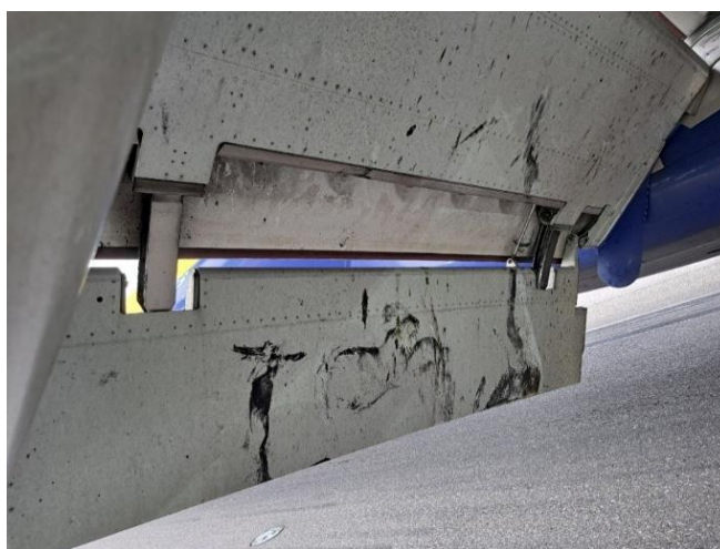
Foto 20: danneggiamenti inner flap lato destro.
