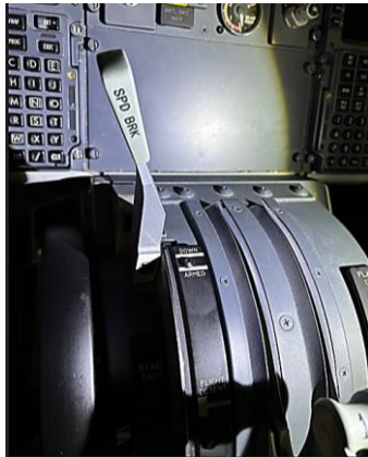
Foto 3: leva comando speedbrakes (immagine copyright della società Boeing. Riprodotta su autorizzazione).
