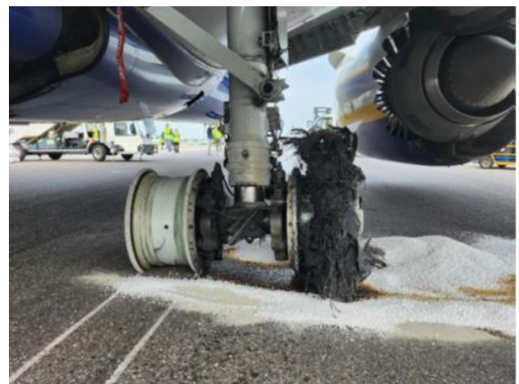
Foto 10: dettaglio visione posteriore del carrello principale destro dell'aeromobile (fonte SACBO).
