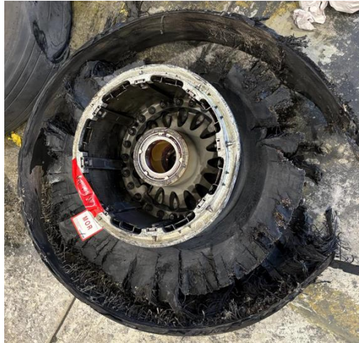
Foto 16: ruota 4 con relativo pneumatico.
