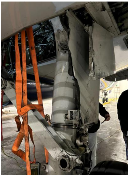
Foto 17: struttura, pannellatura, leveraggi gamba carrello destra.
