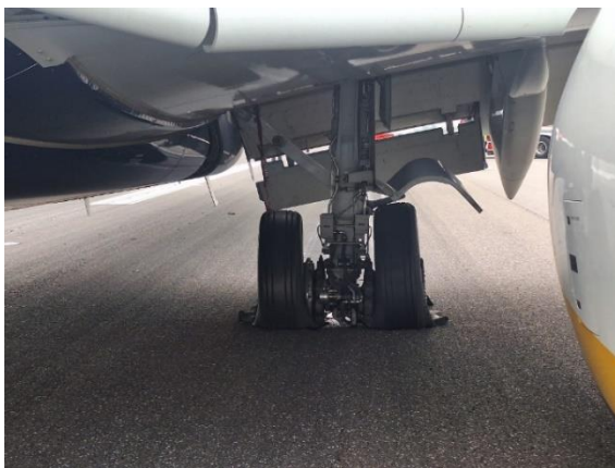
Foto 9: Dettaglio visione anteriore del carrello principale sinistro dell'aeromobile (fonte SACBO).
