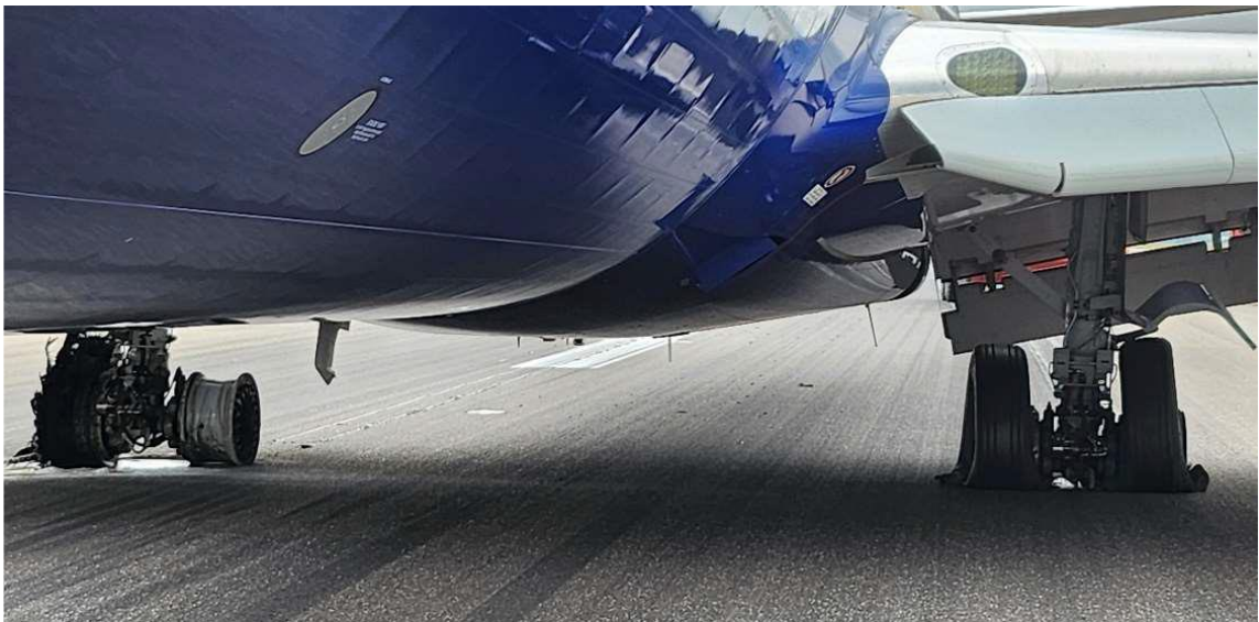
Foto 2: dettaglio danneggiamento ruote - vista anteriore (fonte SACBO).
