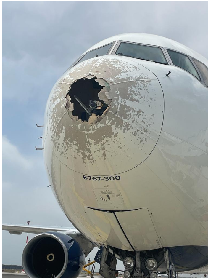
Danni causati dalla grandine.
