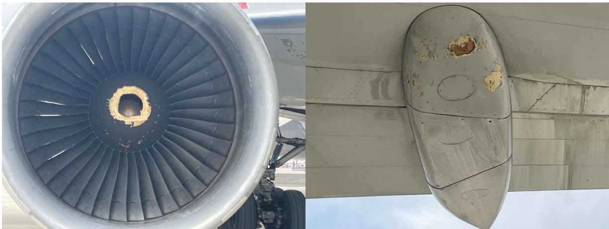
Altri danni causati dalla grandine.
