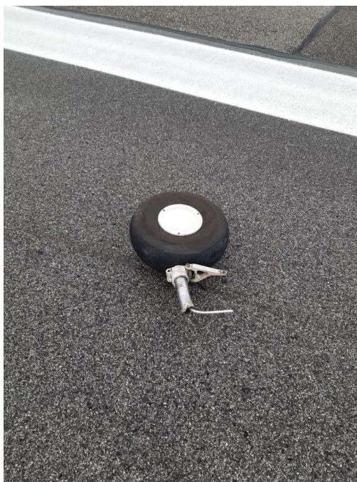
Foto 6: parte della gamba carrello destra distaccatasi.
