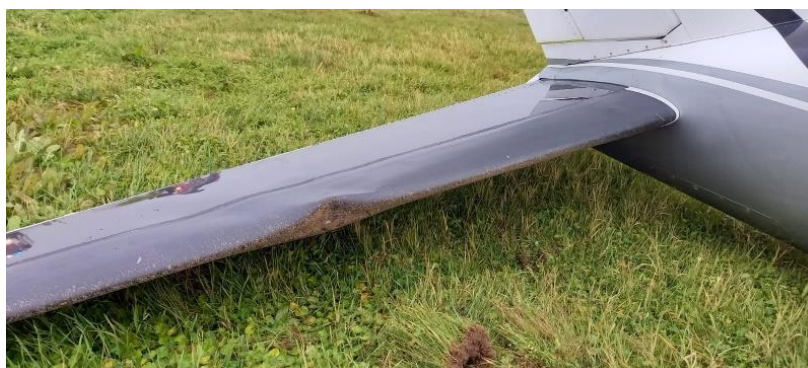
Foto 4: danneggiamenti del piano di coda destro.
