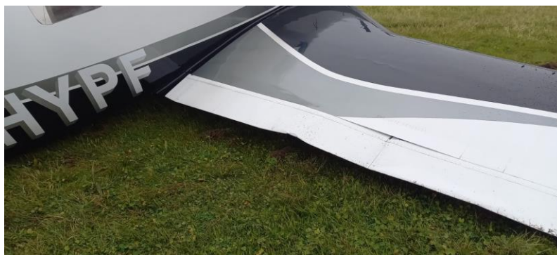
Foto 3: danneggiamenti sulla semiala destra.
