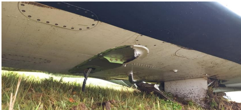
Foto 2: danneggiamenti della parte inferiore della semiala destra.
