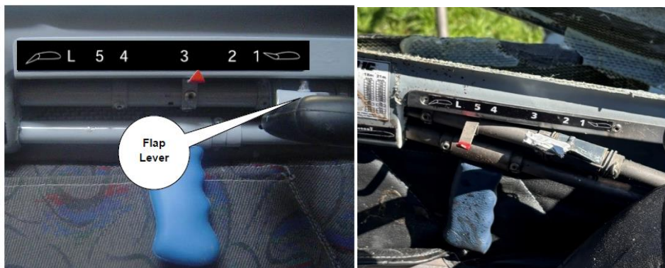
Foto 11: leva flap, a sinistra la rappresentazione del manuale di volo e a destra quanto riscontrato in sopralluogo.
