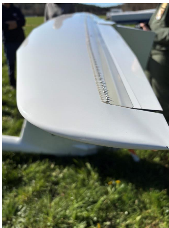
Foto 7: stabilizzatore orizzontale, rimontato in fase di sopralluogo operativo.
