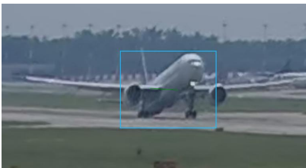
Foto 6: 11.26'42'' inizio contatto della coda dell'aeromobile con la pista.
