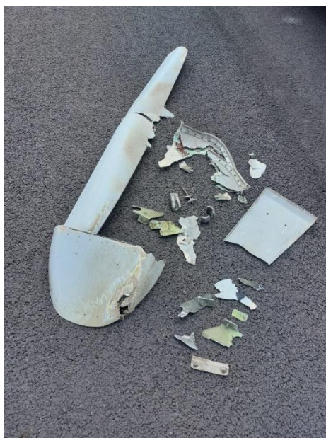
Foto 2: parti di carenatura del tail skid assembly rinvenuti in pista.
