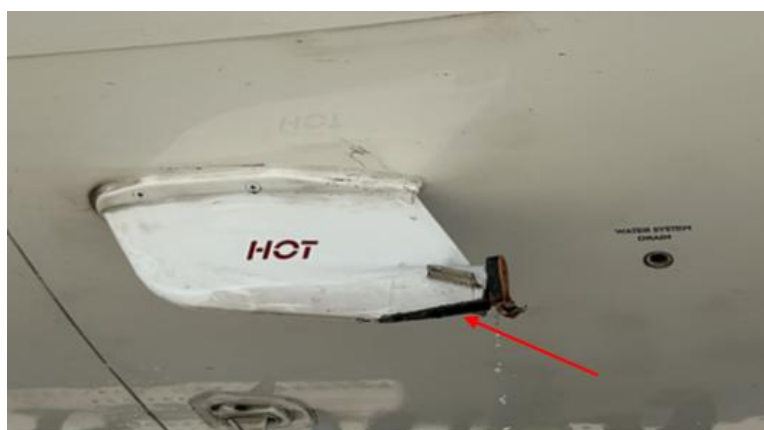
Foto 3: drain mast , indicato dalla freccia il dettaglio del danneggiamento.
