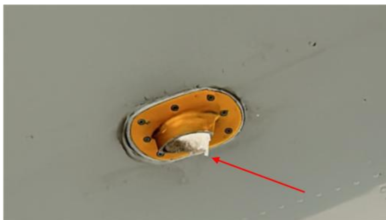
Foto 4: tail strike sensor , indicato dalla freccia il dettaglio del danneggiamento.
