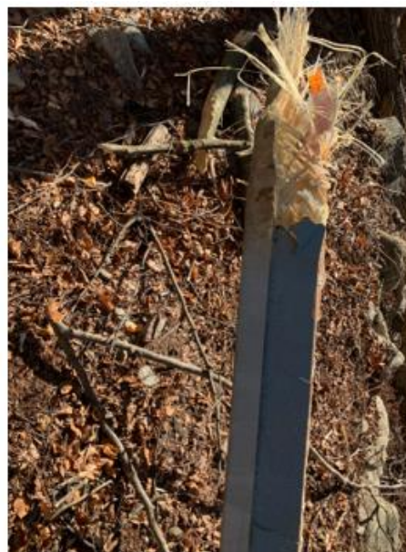
Foto 18 a sinistra e Foto 19 a destra: particolari dei danneggiamenti alle pale del rotore principale.
