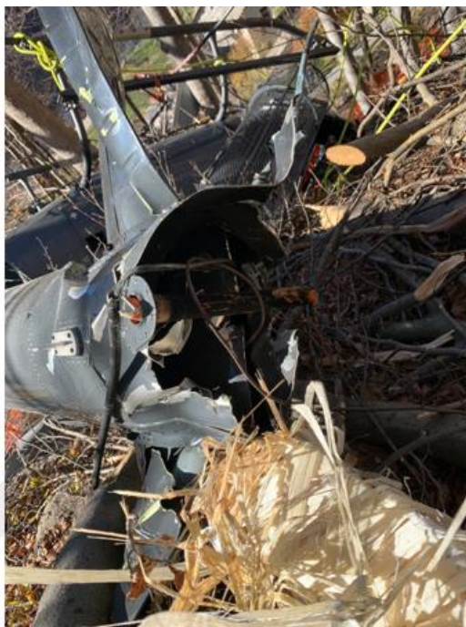
Foto 17: trave di coda priva della parte terminale e relativo rotore.
