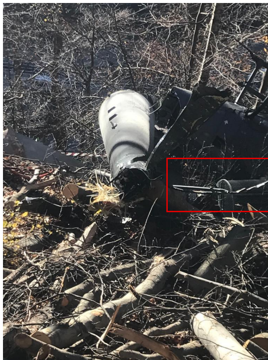
Foto 25: rottura delle flange dell'albero di trasmissione del moto al rotore di coda.
