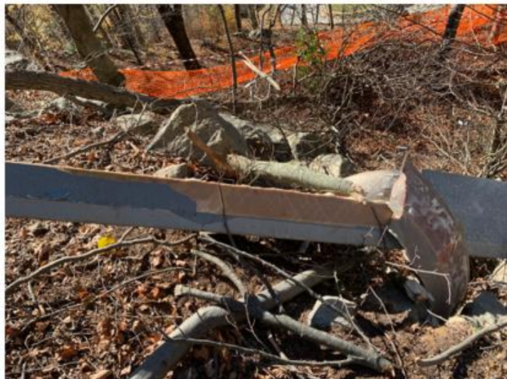
Foto 18 a sinistra e Foto 19 a destra: particolari dei danneggiamenti alle pale del rotore principale.
