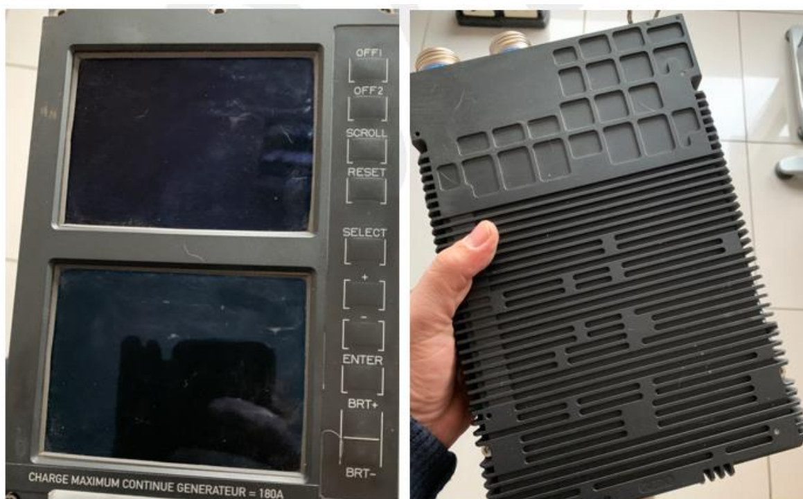
Foto 5 a sinistra e Foto 6 a destra: particolari del VEMD (a sinistra) e DECUC (a destra) installati a bordo dell'elicottero AS 350 B3, marche I-AMVV.
