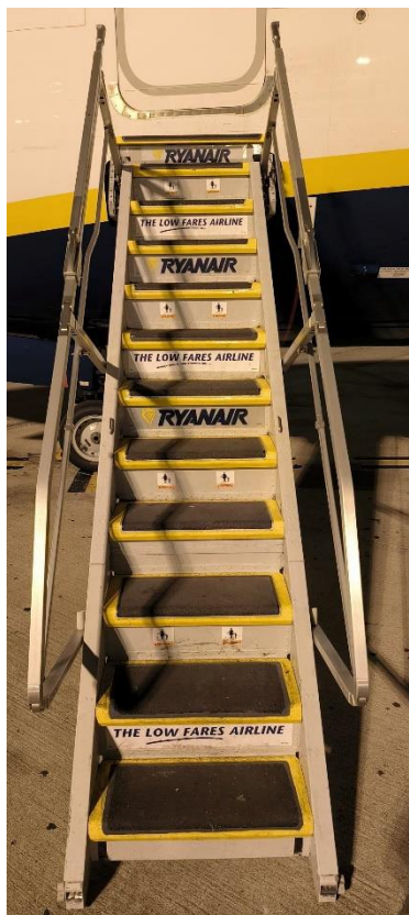
Foto 6: vista frontale della scala integrata del B737.
