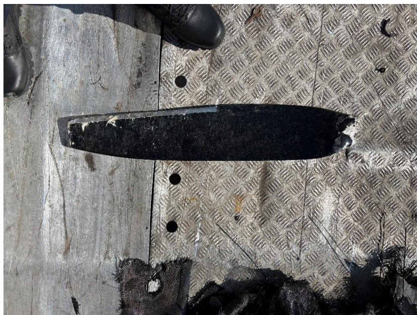
Foto 9: pala separata alla radice e priva di segni di incendio.
