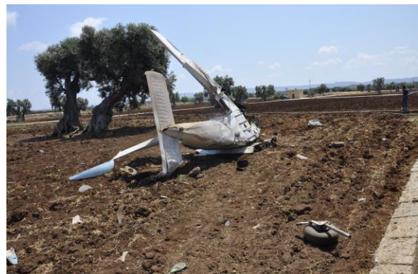
Foto 6: in primo piano, gamba carrello destro.
