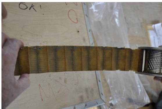
Foto 37 e 38: a sinistra, filtro olio in carta esploso; a destra, contaminazione metallica nel bicchiere filtro olio.
