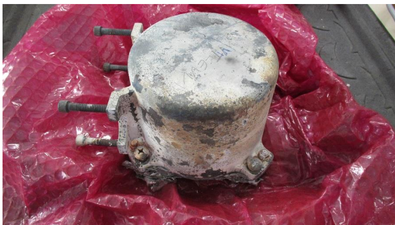
Condizioni della Crash Survivable Memory Unit del recorder combinato dell'A109S marche VT-EVV a seguito dell'incidente.
