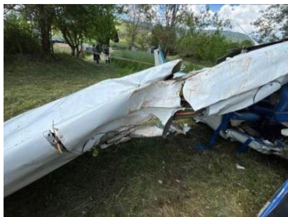
Foto 7: segni di impatto della semiala destra con vegetazione.
